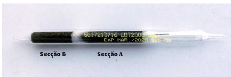
Figura 2.10- Tubo de vidro contendo carvão ativado.
