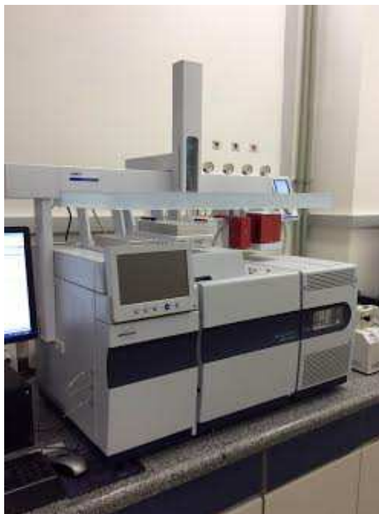
Figura 2.18 - Cromatógrafo gasoso de alta resolução acoplado a um espectrômetro de massas (CGAR-EM).
