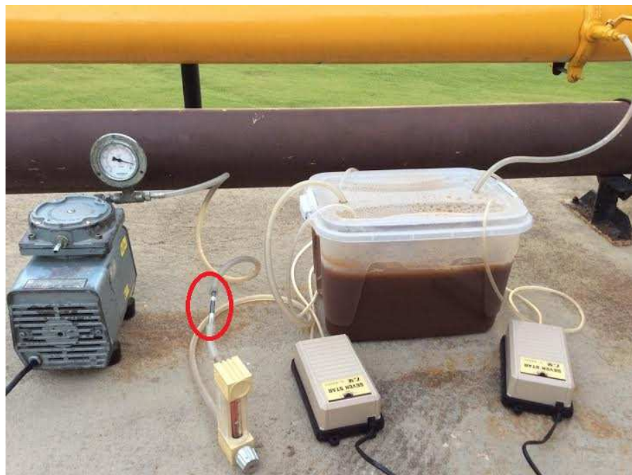
Figura 2.12 – Adsorção dos gases captados na saída do biorreator aeróbio, pós-tratamento.
