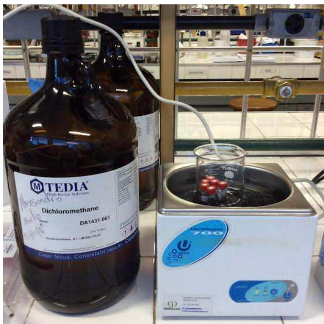
Figura 2.17 - Vials com solvente e carvão ativado durante o processo de ultrasson.
