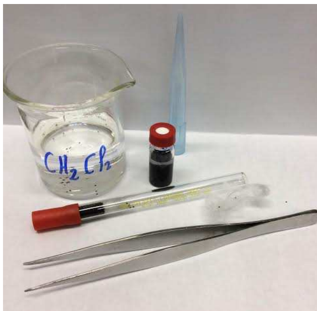
Figura 2.16 - Procedimento de rompimento do tubo de carvão ativado para dessorção química dos compostos orgânicos voláteis.
