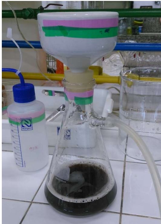
Figura 21: Foto do aparato de filtração usado nas amostras de lixiviados de RSU.
