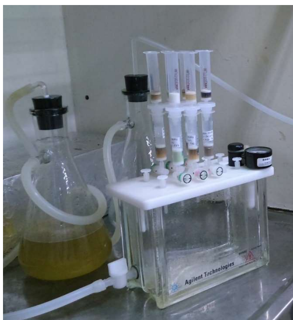
Figura 23: Foto dos cartuchos STRATA SAX acoplado ao cartucho OASIS HLB na etapa de passagem da amostra pelos cartuchos durante a EFS.
