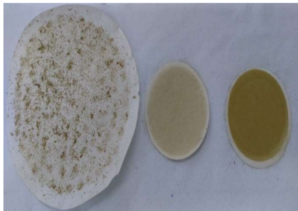
Figura 22: Foto do papel de filtro e membranas utilizadas no processo de filtração das amostras de lixiviados de RSU.
