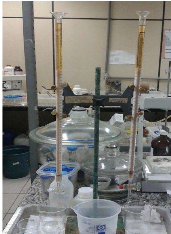
Figura 17: Foto do aparato com resina XAD-8 utilizado na separação das frações AF e HYI.
