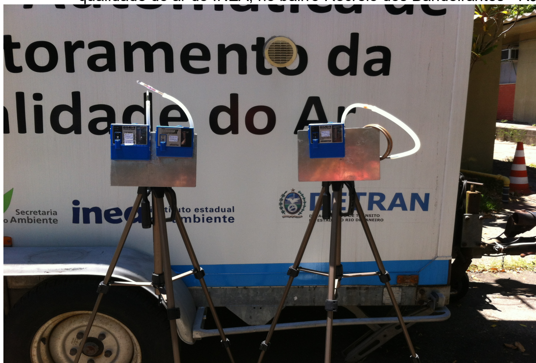
Figura 9 - Amostragem dos COVs em frente à estação de monitoramento da qualidade do ar do INEA, no bairro Recreio dos Bandeirantes - RJ.
