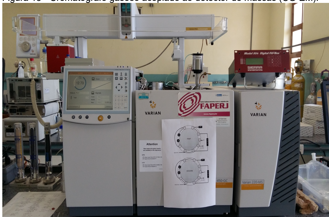
Figura 13 - Cromatógrafo gasoso acoplado ao detector de massas (CG-EM).
