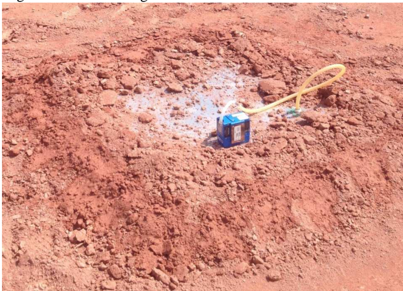
Figura 37 – Coleta de gases BTEX na camada de cobertura.
