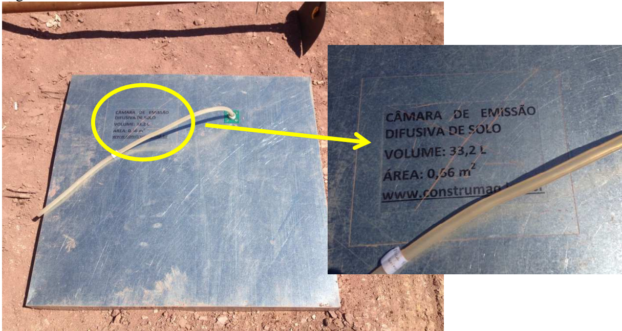
Figura 27 – Câmara de fluxo de 0,66 m 2 de área e 33,2 L de volume.
