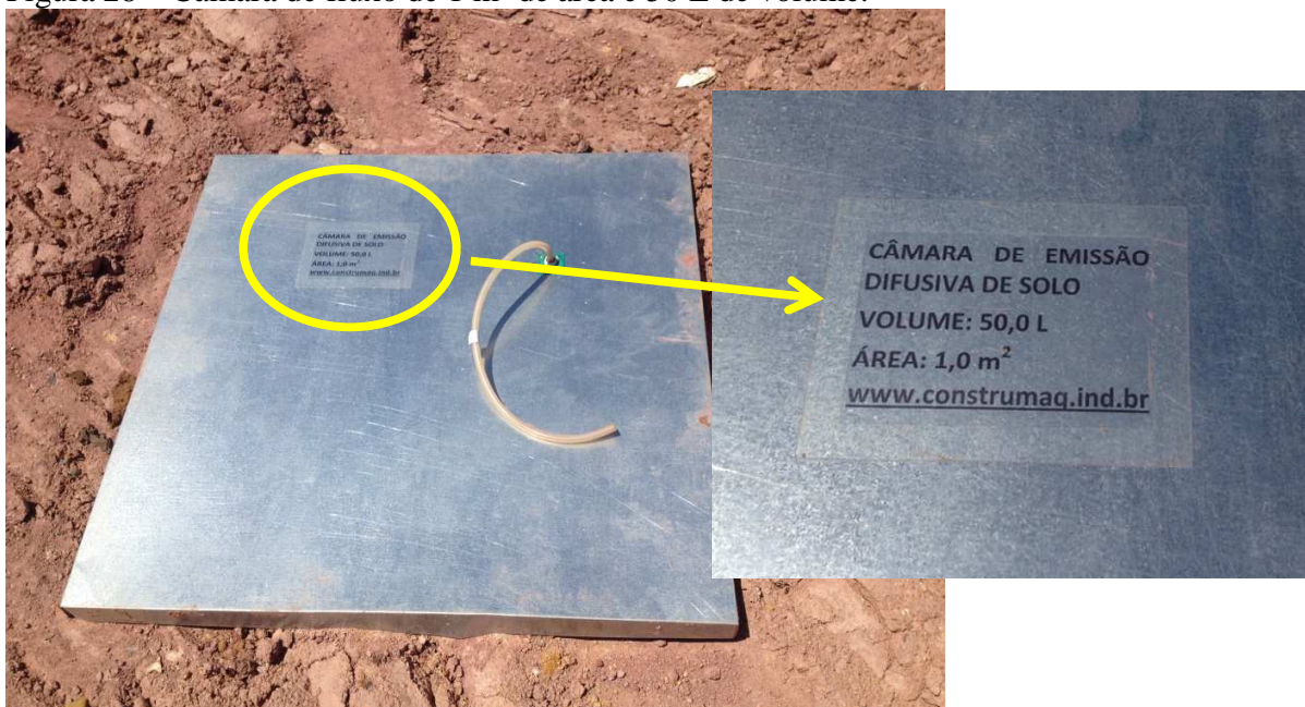
Figura 28 – Câmara de fluxo de 1 m 2 de área e 50 L de volume.
