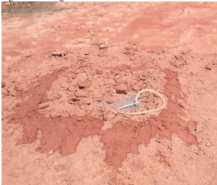
Figura 35 – Imagem da câmara de fluxo cravada.
