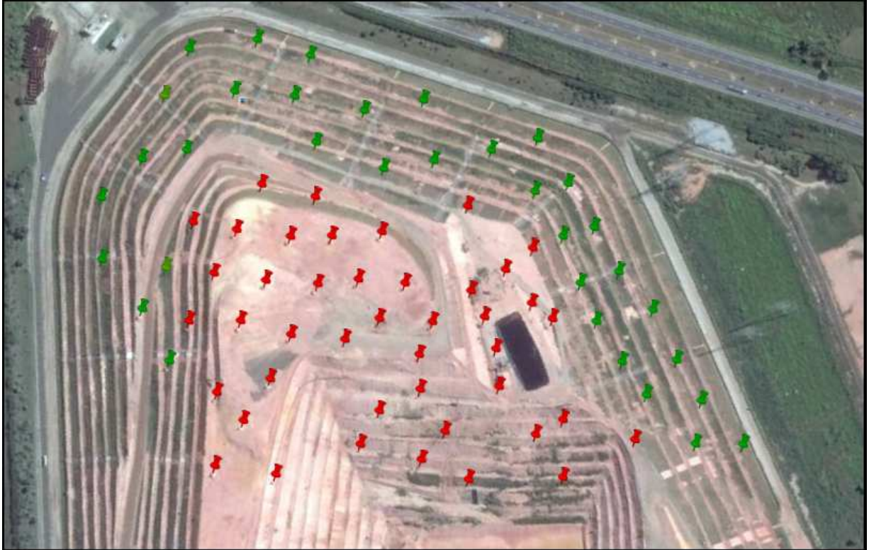
Figura 23 – Posicionamento dos poços de captação de gases passivos (vermelho) e ativos (verde) na célula 1 do aterro.
