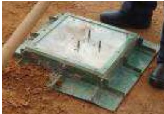
Figura 28 – Placa de Fluxo de 0,16 m 2 de área e 8,3 L de volume.
