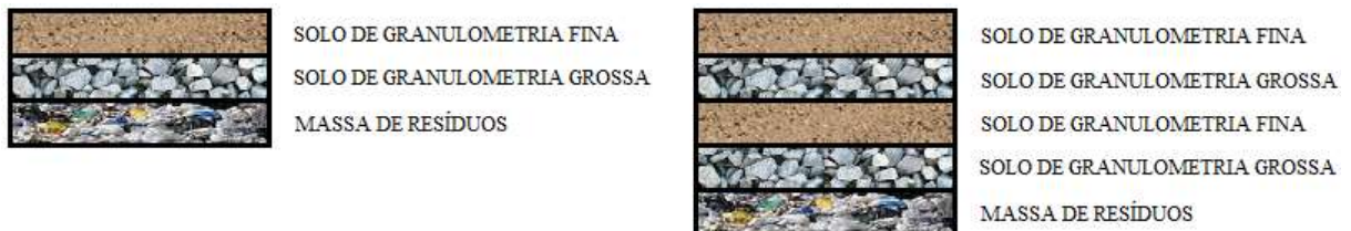
Figura 7 – Esquema de sistemas de cobertura barreira capilar simples e dupla.
