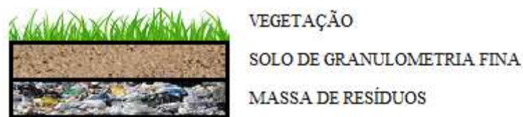
Figura 8 – Esquema de sistema de cobertura evapotranspirativa.
