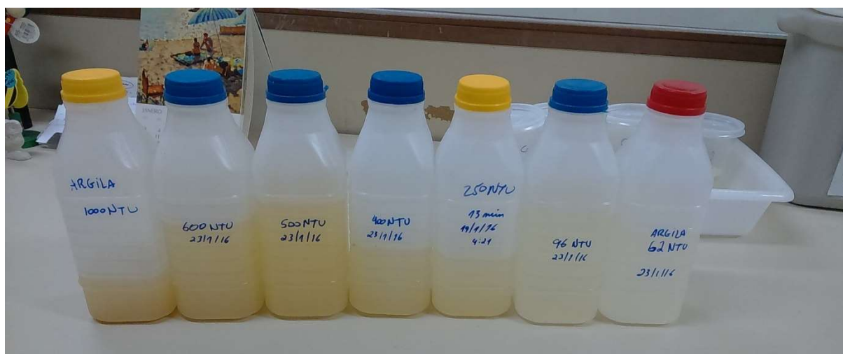
Figura 20: Suspensão padrão de argila com valores de 1000 até 62 NTU
