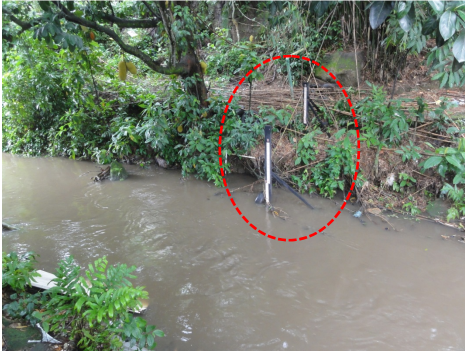
Figura 16 – Estação fluviométrica (Water Planet) instalada no rio Morto, próxima do exutório da bacia
