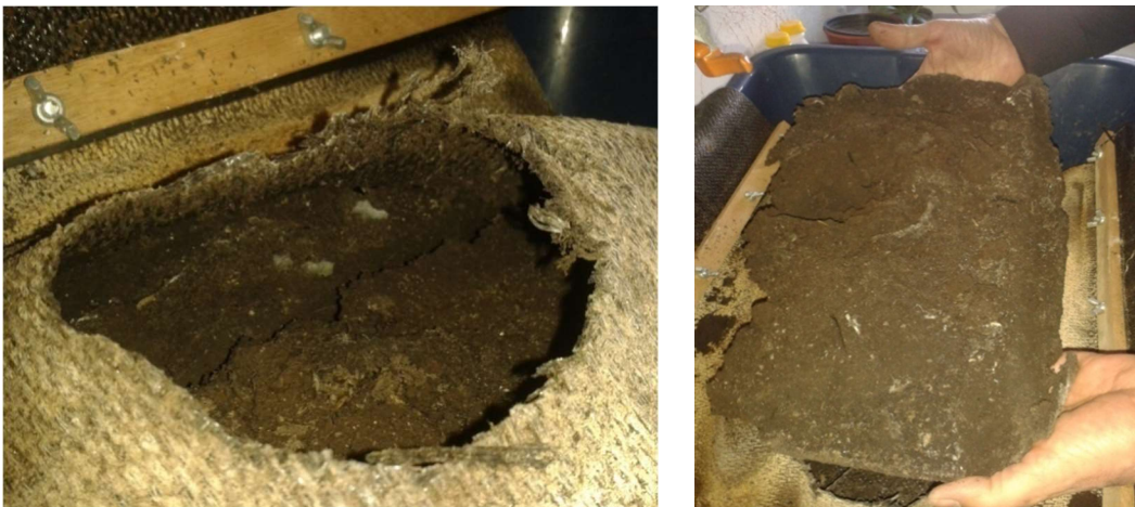
Figura 35 – Material do interior do geobag após o fim da operação
