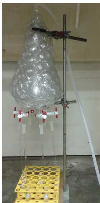
Figura 16: Foto do aparato utilizado na secagem das amostras com fluxo de nitrogênio
