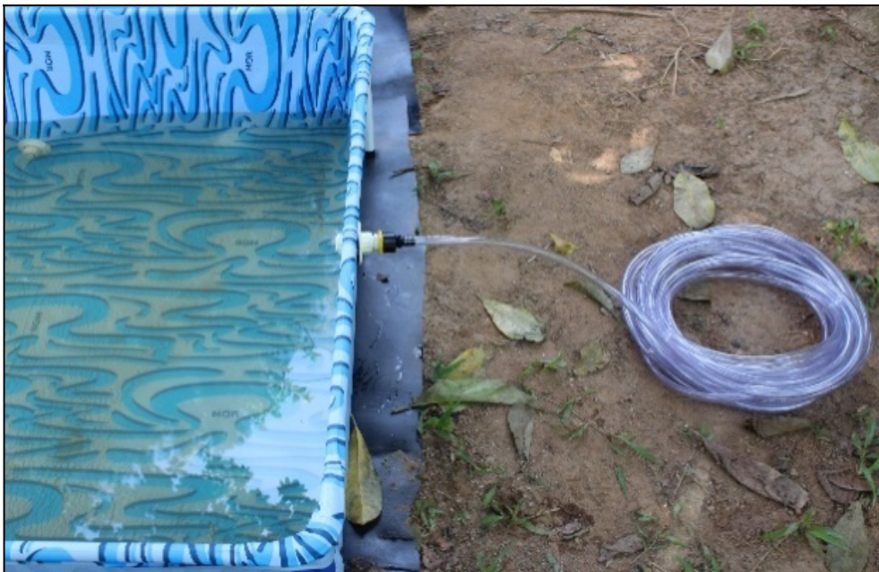
Figura 3-6 - Entrada na primeira piscina, mangueira ligada ao bico de mangueira e ao flange
