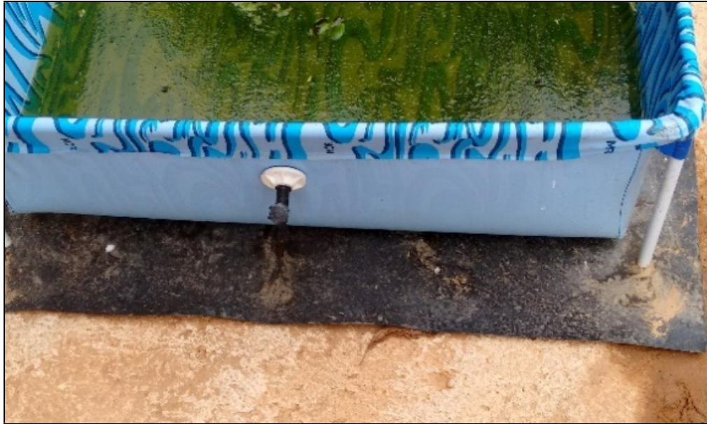
Figura 3-7 – Torneira ligada a piscina por flange
