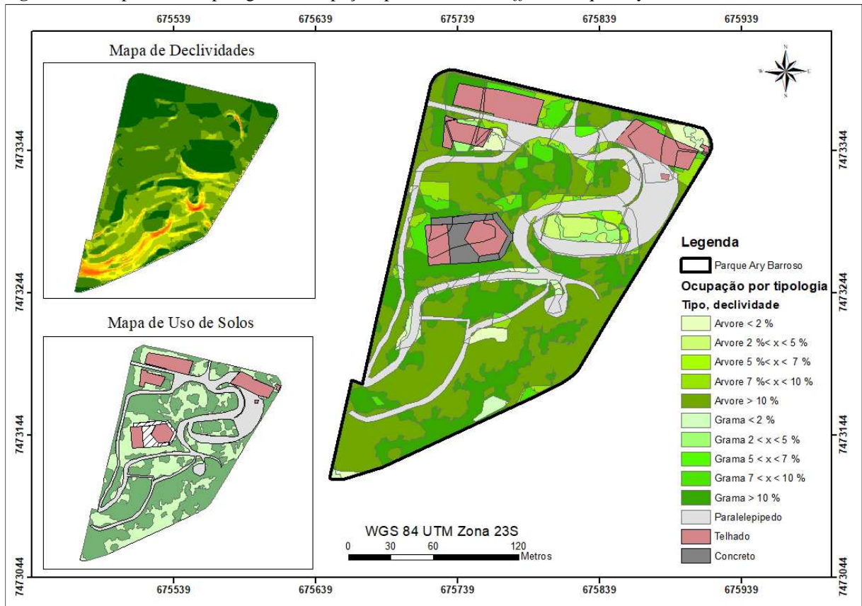
Figura 18 - Mapa com as tipologias de ocupação, por valor de runoff , do Parque Ary Barroso
