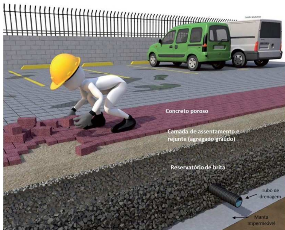
Figura 5 - Pavimento permeável: sistema revestido com peças intertravadas de concreto poroso.
