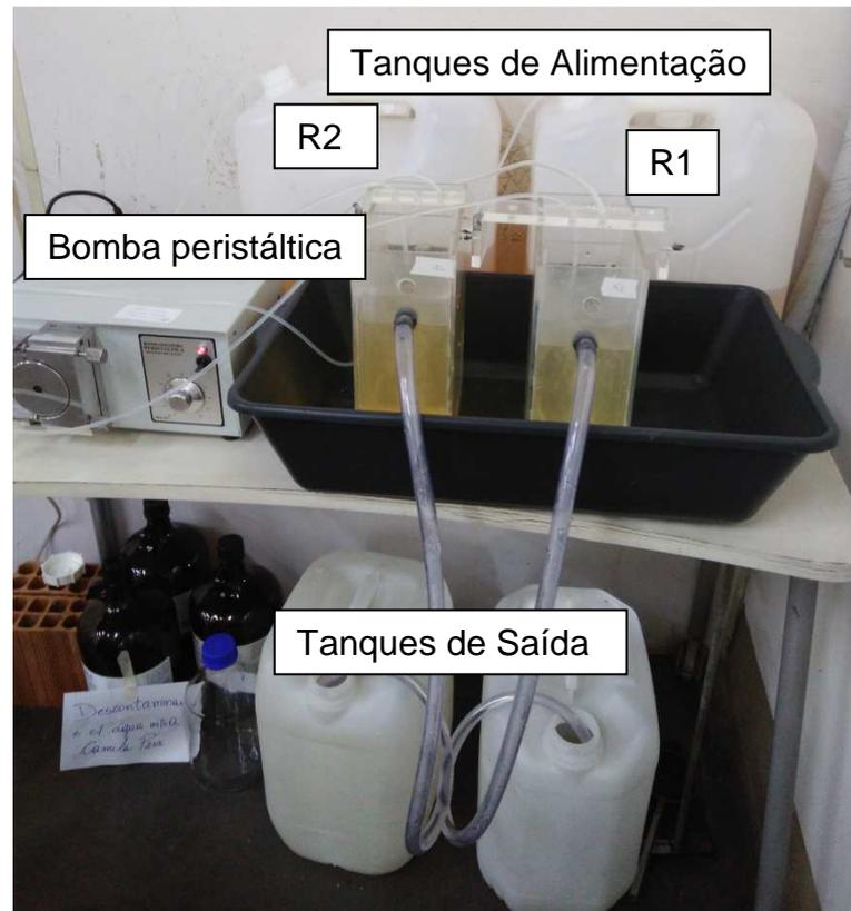
Foram utilizados 2 reatores biológicos em escala de bancada, em acrílico transparente, com volume total de 3,8 L. Os reatores foram baseados no modelo de Eckenfelder (1989) e possuíam 2 compartimentos: o tanque de aeração com 2,8 L e o decantador com 1 L. A Figura 13 apresenta as dimensões dos reatores.
