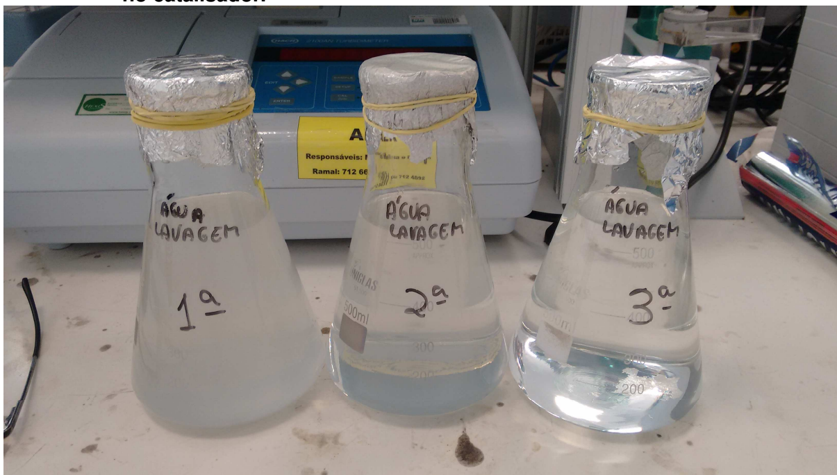
Figura 31 - Amostras de água proveniente de cada uma das três lavagens realizadas no catalisador.
