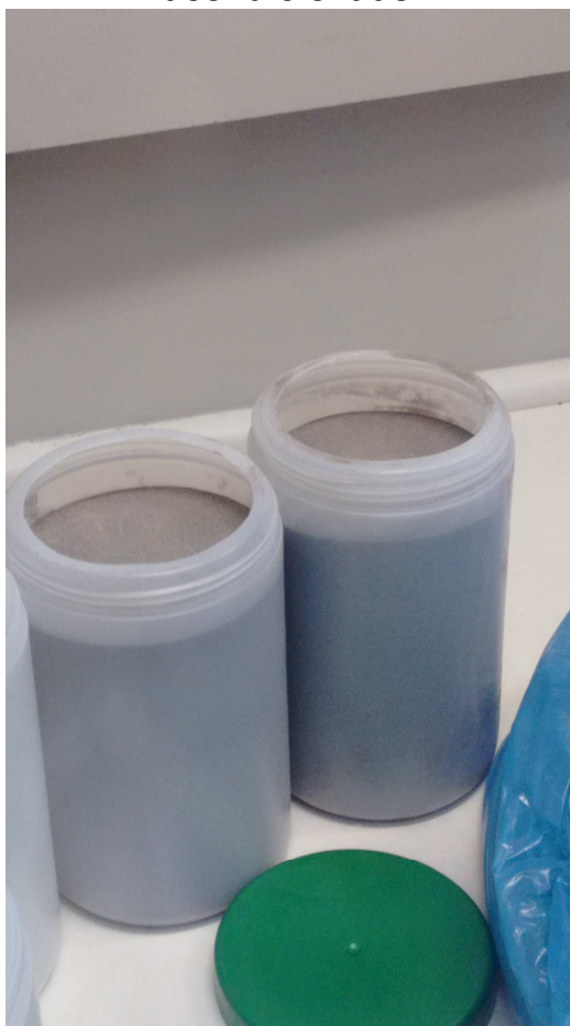
Figura 21 - Catalisador exaurido acondicionado.
