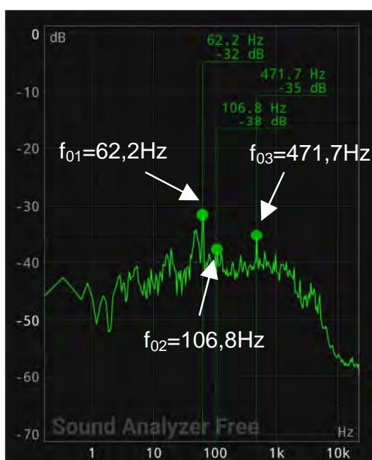
Figura 51 - Frequências da plataforma via análise numérica ( f_{01}=62,2\text{Hz} )
