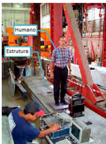
Figura 14 - Pessoa em pé sobre o sistema estrutural [Adaptado de Brownjohn, 1999]
