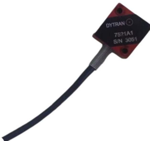
Figura 55 - Acelerômetro Dytran (transdutor de aceleração capacitivo)
