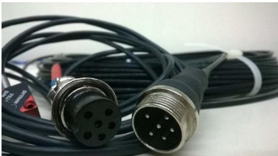
Figura 56 - Acelerômetro Dytran. Conector fêmea (esq.) / Conector macho do cabo (dir.).
