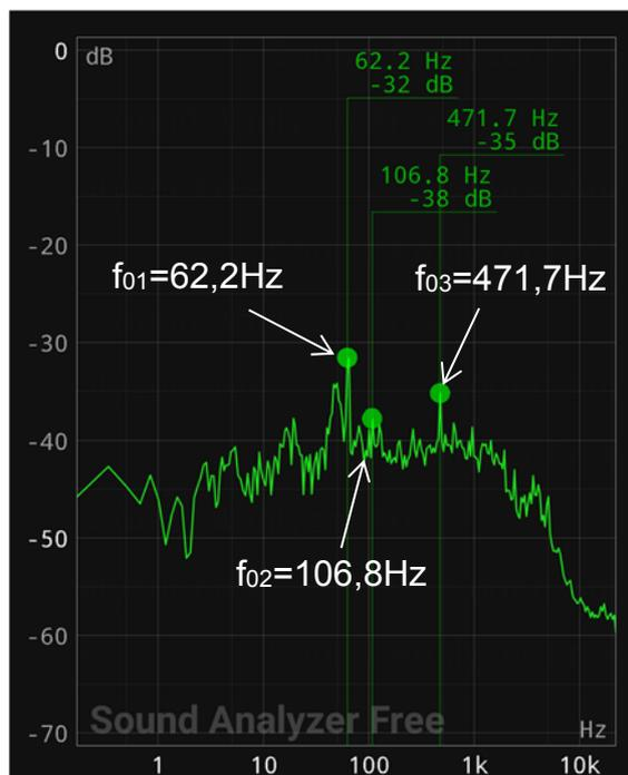
Figura 61 - Frequência fundamental da plataforma via análise experimental ( $f=62,2\text{Hz}$ )
