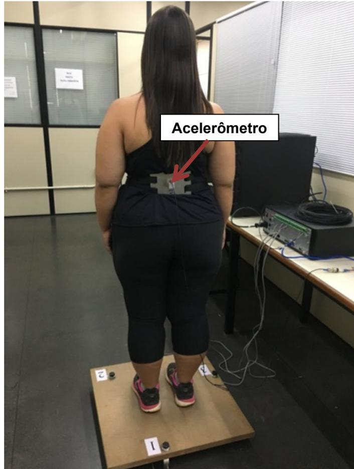
Figura 46 - Posicionamento do acelerômetro no centro de gravidade do indivíduo
