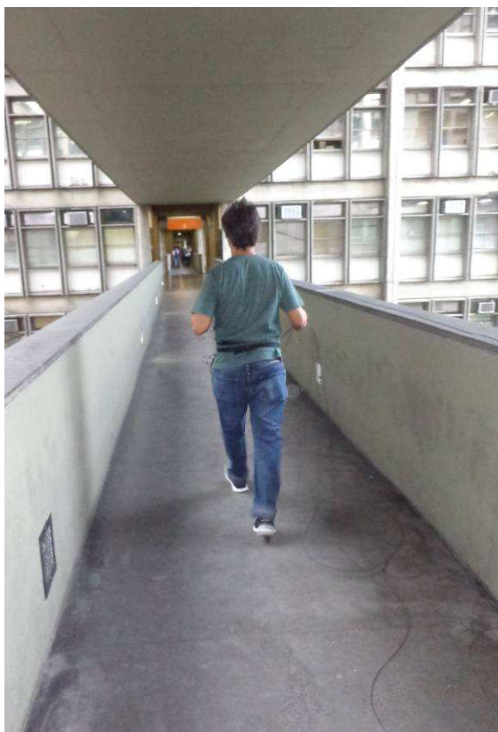
Figura 372 – Ensaio 13: um pedestre em caminhada lenta ( f_p=1,6 Hz).
