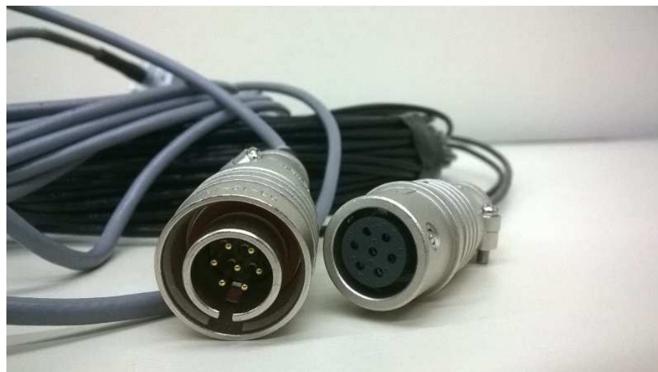
Figura 61 – Acelerômetro Kyowa. Conector macho (esq.) / Conector fêmea do cabo (dir.).
