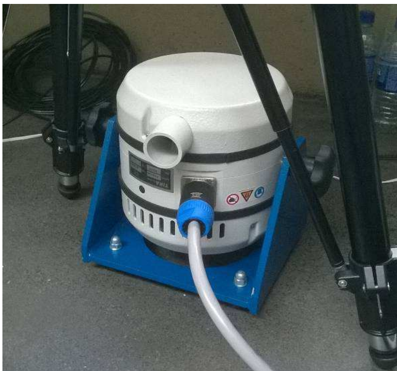
Figura 145 – Ensaio 4: Shaker (excitador de vibração do tipo TIRAvib – S 51140-M).
