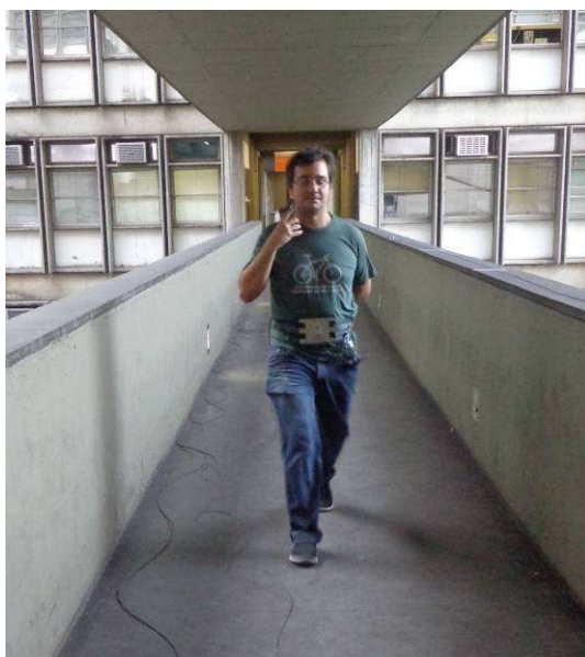
Figura 399 – Ensaio 16: um pedestre em caminhada normal ( f_p=2,3 Hz).
