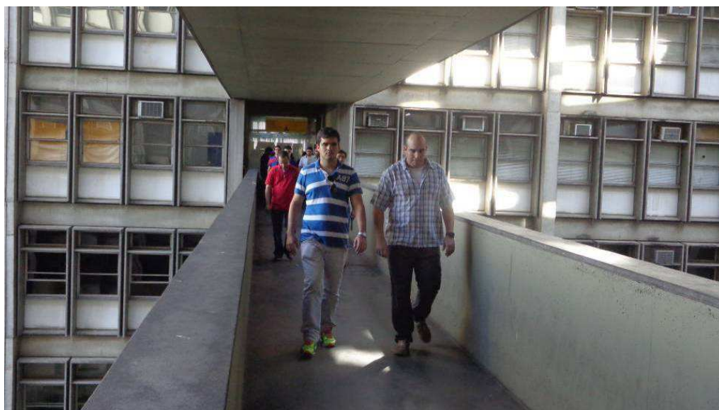
Figura 180 – Ensaio 1: pedestres em caminhada lenta ( f_p=1,6 Hz).
