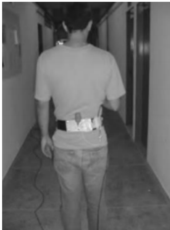
Figura 42 – Indivíduo caminhando com um acelerômetro acoplado em seu centro de gravidade aproximado [115].
