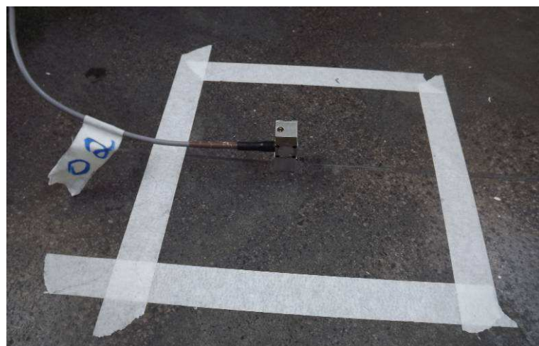
Figura 90 – Ensaio 1: posicionamento dos acelerômetros Kyowa – Ponto 2.
