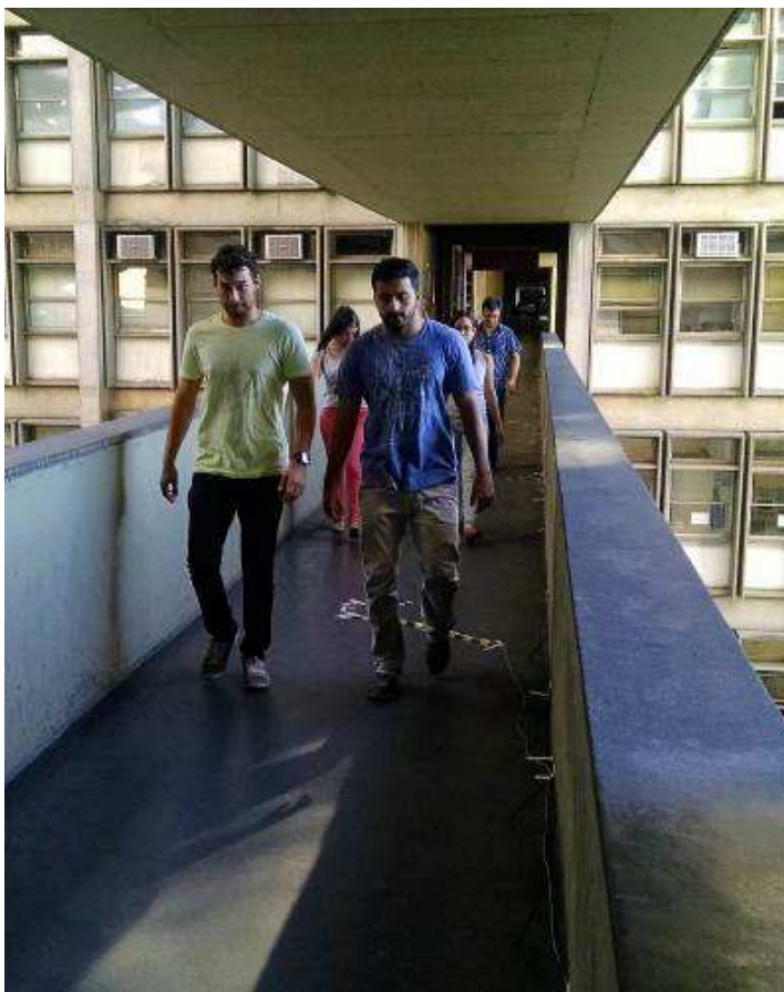
Figura 448 – Teste experimental com pedestres caminhando ( f_p=1,70 Hz: caminhada lenta).
