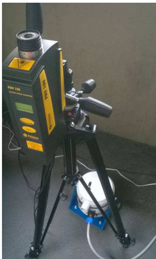
Figura 147 – Ensaio 4: PDV 100 (Vibromêtro Digital Portátil) da Polytec.
