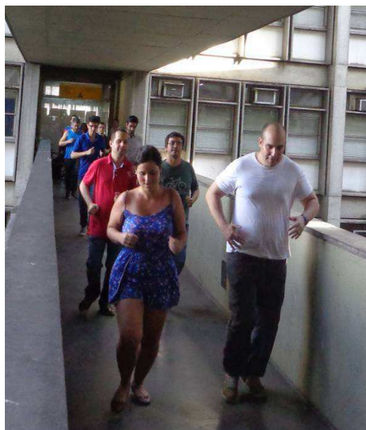
Figura 192 – Ensaio 5: pedestres em caminhada rápida ( f_p=2,45 Hz).
