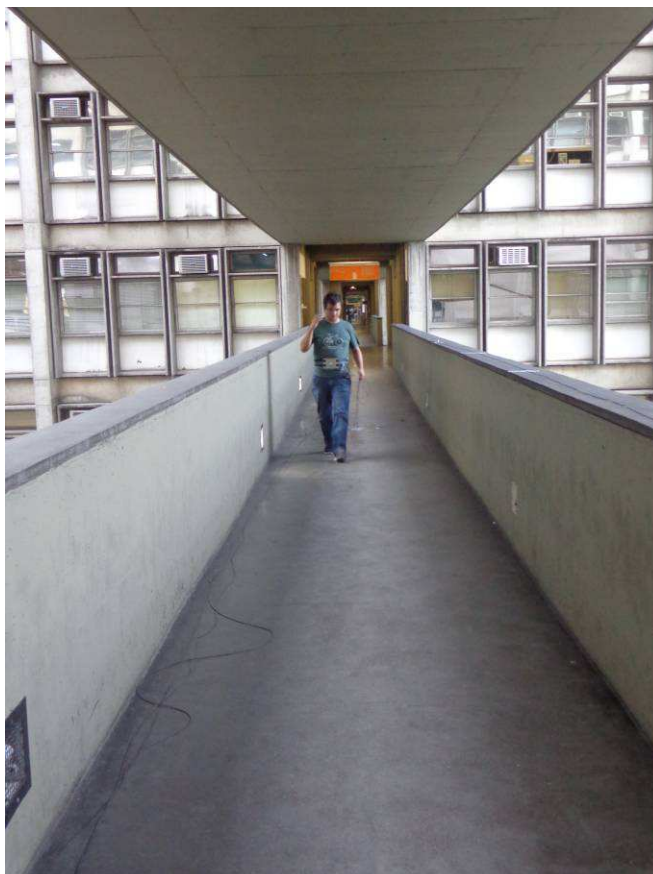
Figura 381 – Ensaio 14: um pedestre em caminhada lenta ( f_p=1,7 \text{ Hz} ).
