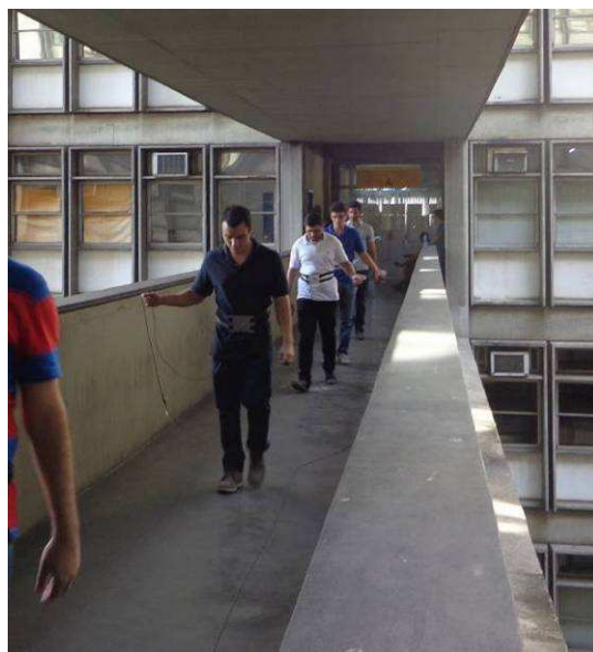
a) ida b) volta Figura 306 – Ensaio 11: pedestres em caminhada rápida ( f_p=2,3 Hz).
