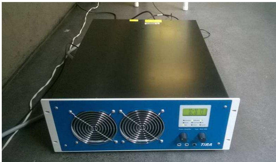
Figura 146 – Ensaio 4: Amplificador de Potência BAA 1000.
