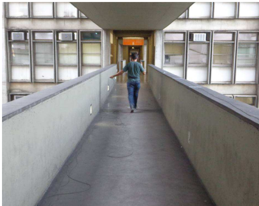
Figura 390 – Ensaio 15: um pedestre em caminhada normal ( f_p=2,0 Hz).
