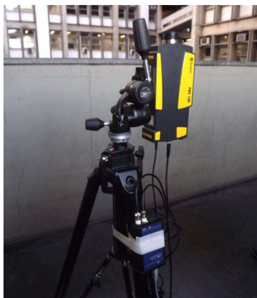
Figura 103 – Ensaio 2: Vibrômetro a laser Polytec (Portable Digital Vibrometer: PDV-100): Vista Lateral.
