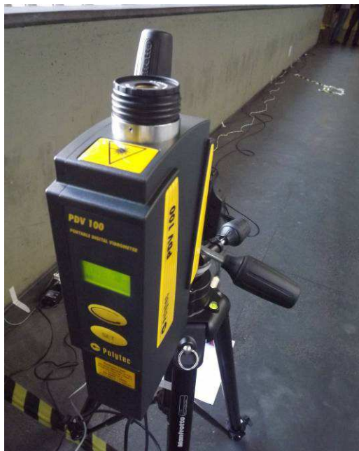
Figura 102 – Ensaio 2: Vibrômetro a laser Polytec (Portable Digital Vibrometer: PDV-100): Vista Frontal.
