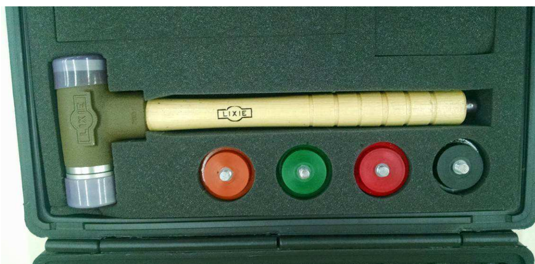
Figura 79 – Martelo de impacto modelo 5802A Dytran Instruments.
