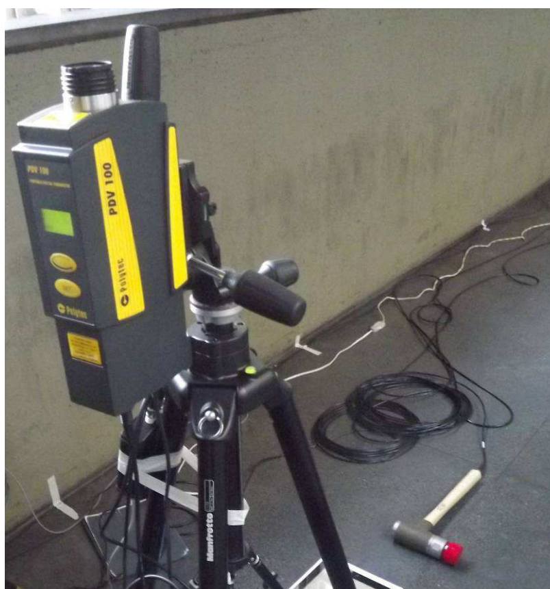
Figura 105 – Ensaio 2: Martelo de impacto Dytran conectado ao PDV 100.
