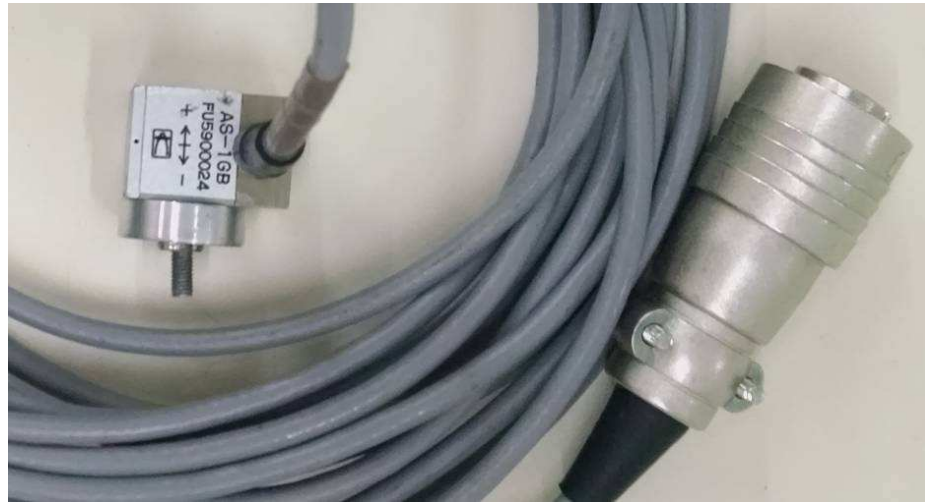
Figura 60 – Acelerômetro Kyowa (transdutor de aceleração resistivo).
