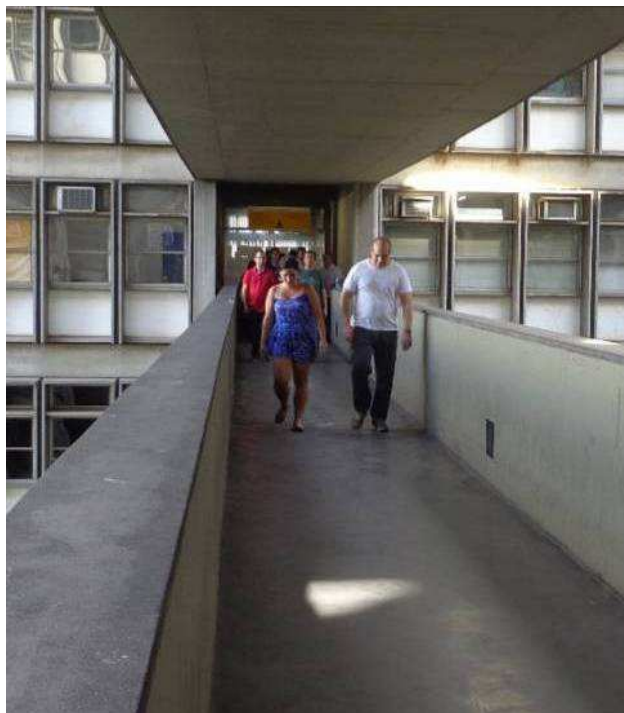
Figura 186 – Ensaio 3: pedestres em caminhada normal ( f_p=2,0 Hz).
