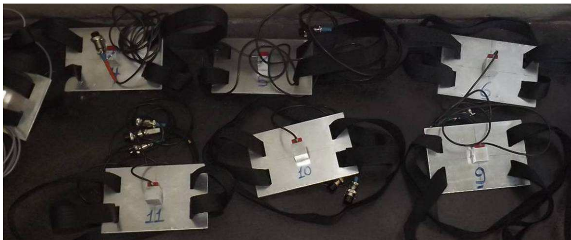
Figura 174 – Conjunto (placa, base, acelerômetro e velcro) de acoplamento nos pedestres.
