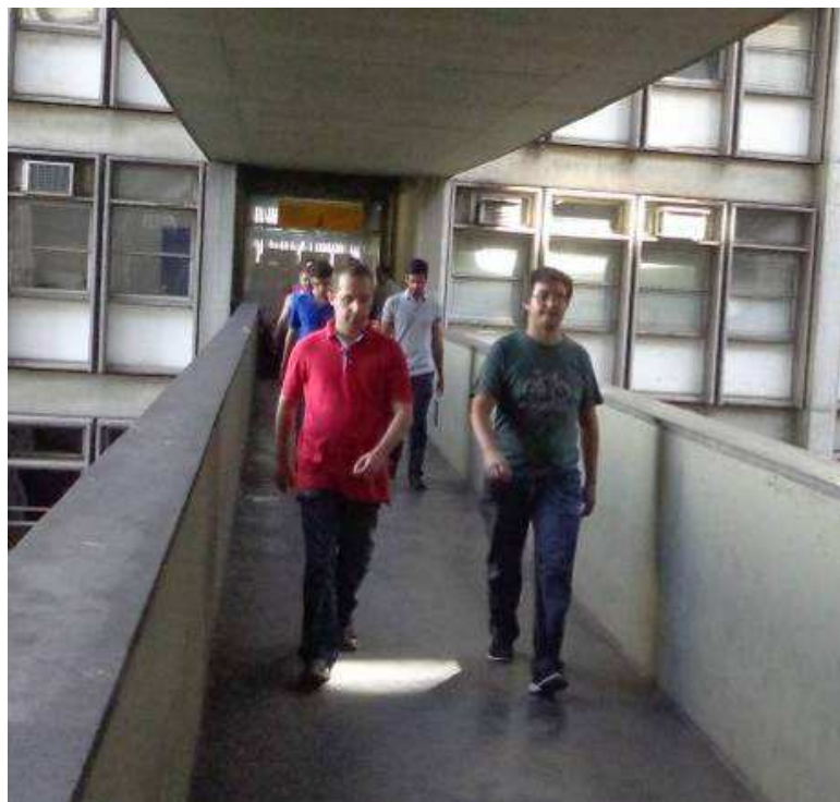
Figura 183 – Ensaio 2: pedestres em caminhada lenta ( f_p=1,7 Hz).
