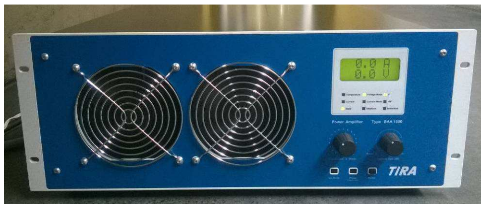
Figura 84 – Amplificador de potência do tipo TIRAvib – BAA 1000.
