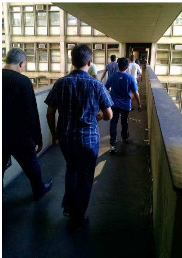
Figura 445 – Teste experimental com pedestres caminhando ( f_p=2,00 Hz: caminhada normal).
