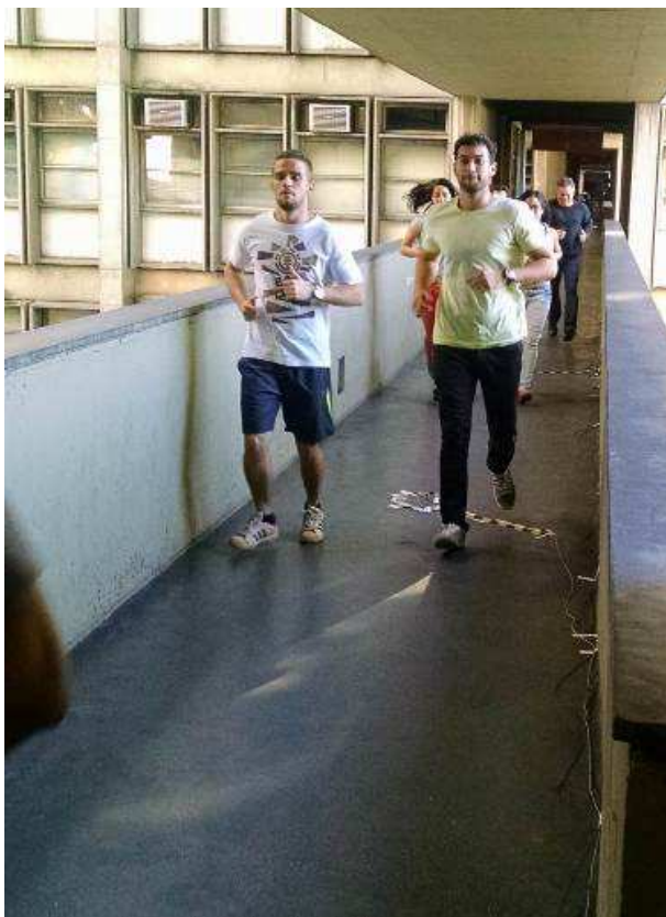
Figura 442 – Teste experimental com pedestres caminhando ( f_p=2,45 Hz: caminhada em ressonância).
