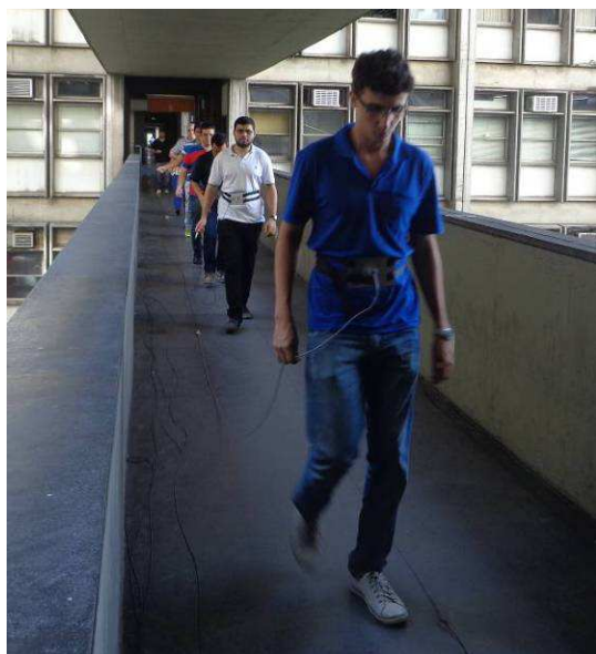
a) ida b) volta Figura 306 – Ensaio 11: pedestres em caminhada rápida ( f_p=2,3 Hz).
