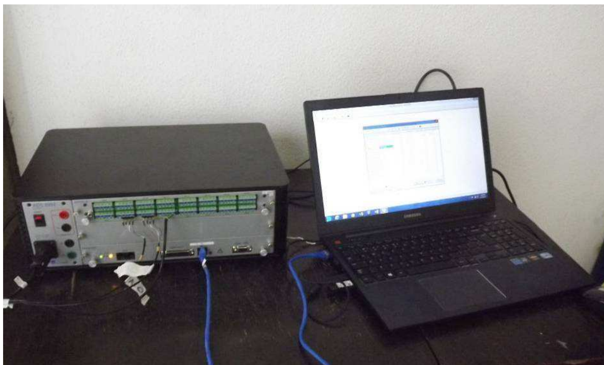
Figura 92 – Ensaio 1: sistema ADS2002 conectado a acelerômetros e controlado por computador.
