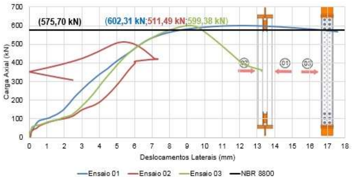
Figura 54 – Carga versus deslocamento (eixo de menor inércia – lateral 02)
