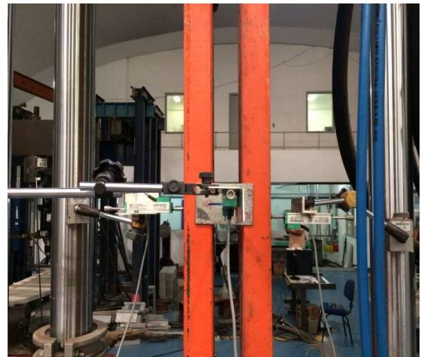
Figura 45 – Ensaio 03: detalhe da instrumentação
