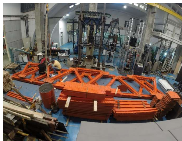
Figura 180 – Passo 02: montagem de módulos da linha de treliça
