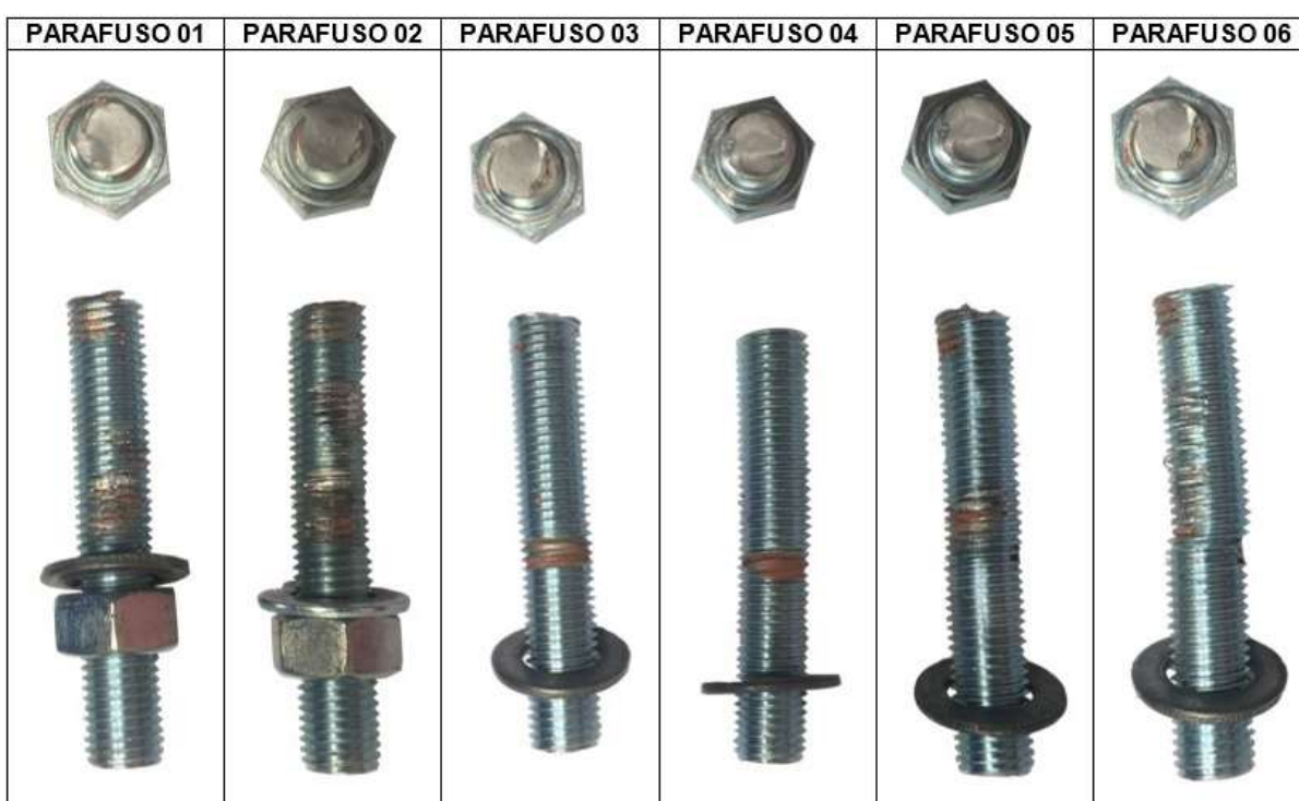
Figura 126 – Ensaio 01: ruína dos parafusos classe 5.8
