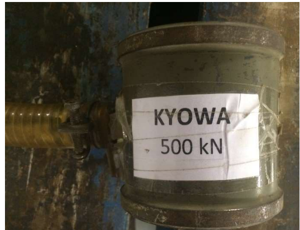
Figura 19 – Célula KYOWA [69]: 500 kN
