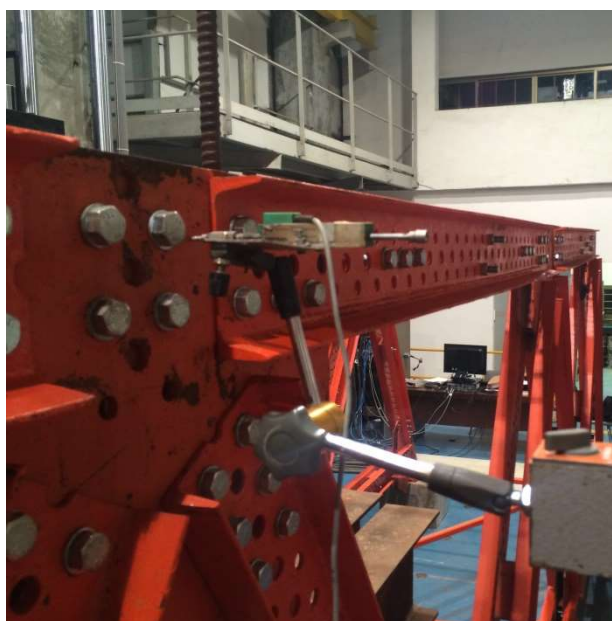
Figura 158 – Ensaio 03: transdutor de deslocamentos laterais do banzo superior estrutura indeformada
