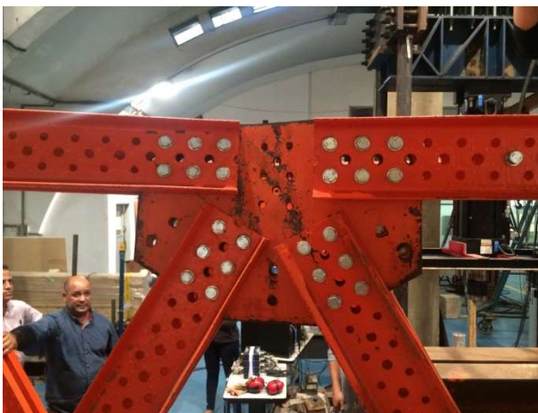
Figura 153 – Ensaio 03: ruína do banzo esquerdo
