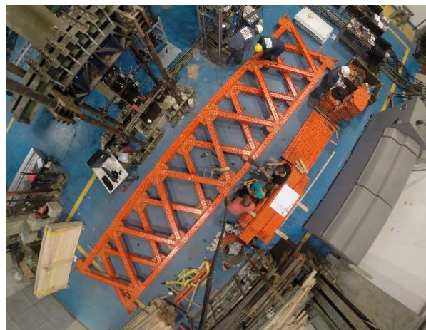
Figura 181 – Passo 03: montagem de módulos da linha de treliça
