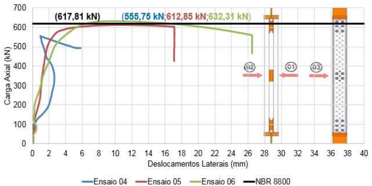
Figura 75 – Carga versus deslocamento (eixo de menor inércia – lateral 02)
