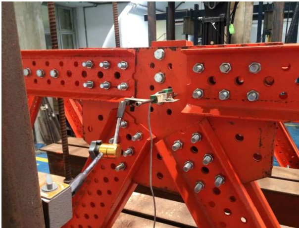
Figura 25 – LVDT [68]: banzo superior esquerdo
