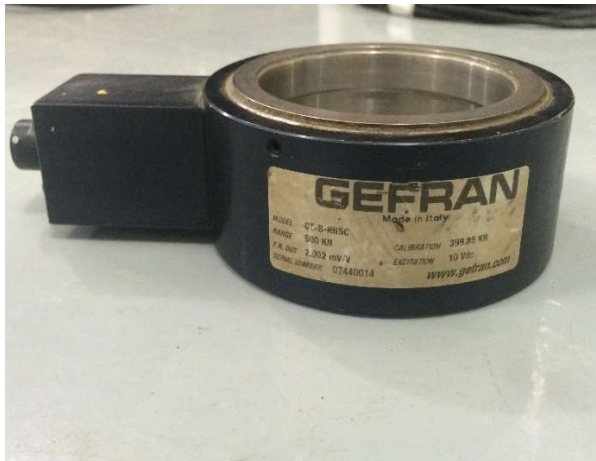
Figura 18 – Célula GEFRAN [67]: 500 kN
