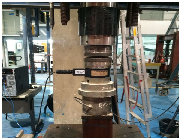
Figura 20 – Calibração das células GEFRAN [67] 14
