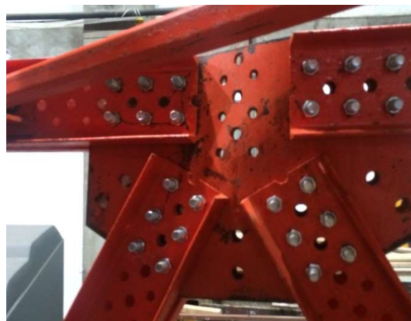
Figura 154 – Ensaio 03: detalhe da ruína do banzo direito
