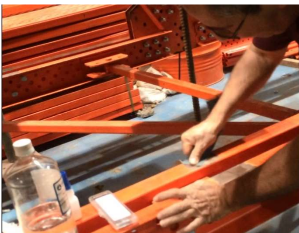
Figura 196 – Preparação da base strain gage 02
