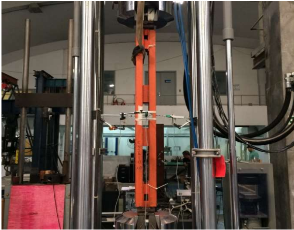
Figura 84 – Ensaio 08: duas chapas espaçadoras
