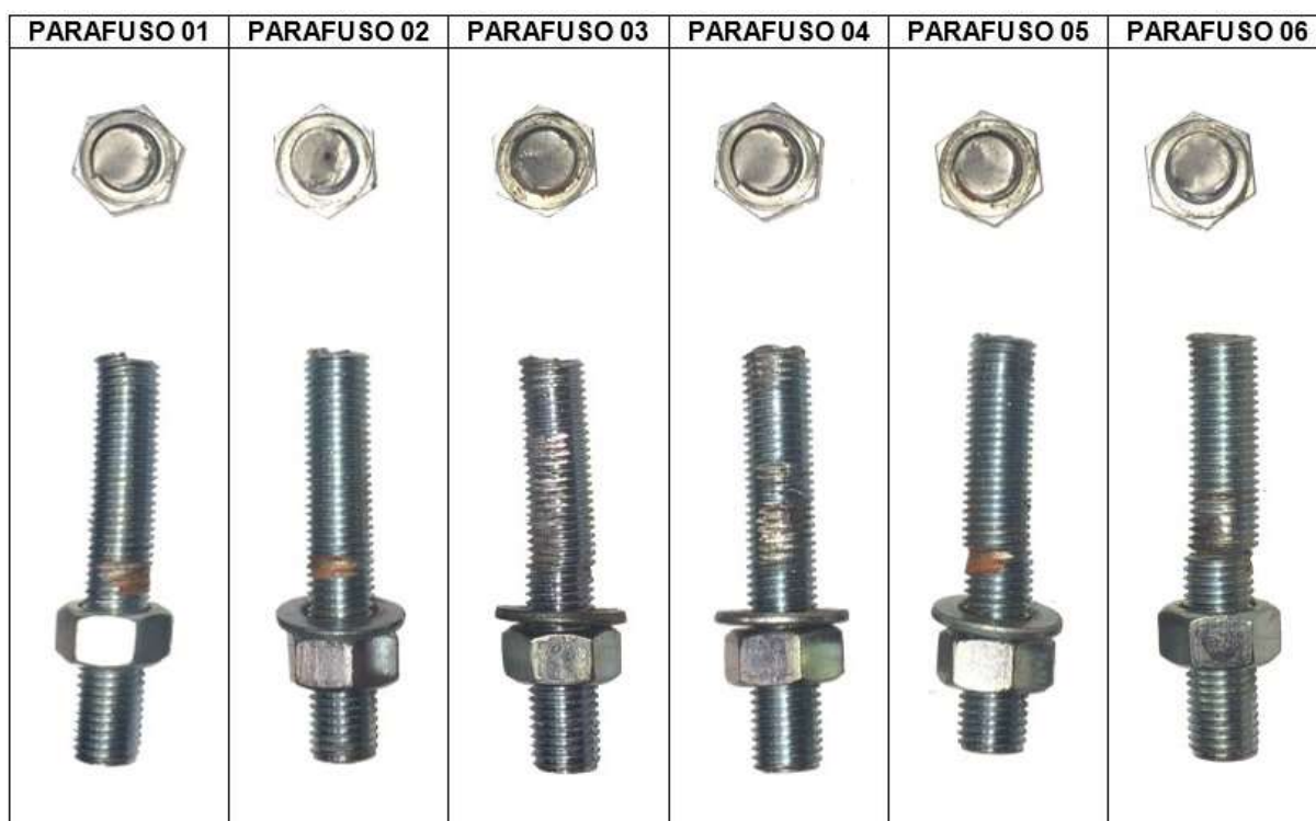
Figura 131 – Ensaio 02: ruína dos parafusos classe 5.8
