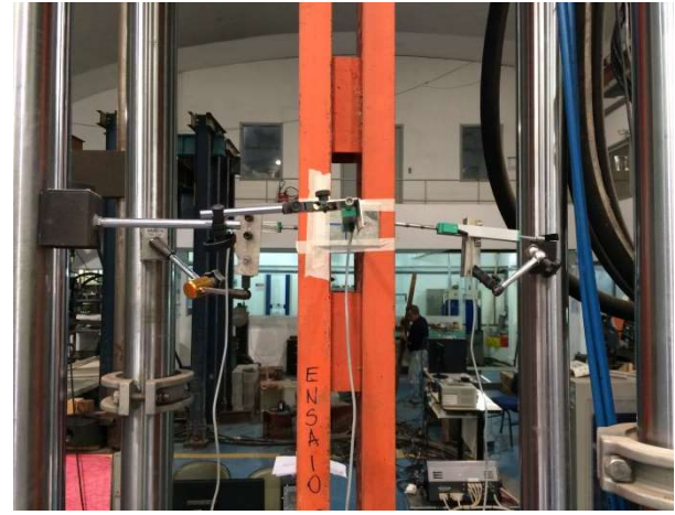
Figura 85 – Ensaio 08: detalhe da instrumentação
