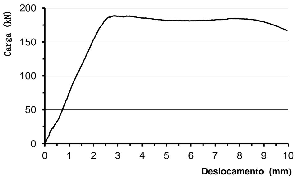
Figura E1 – Curva tensão *versus* deslocamentos LC\_51x51x4,8\_L400\_1
