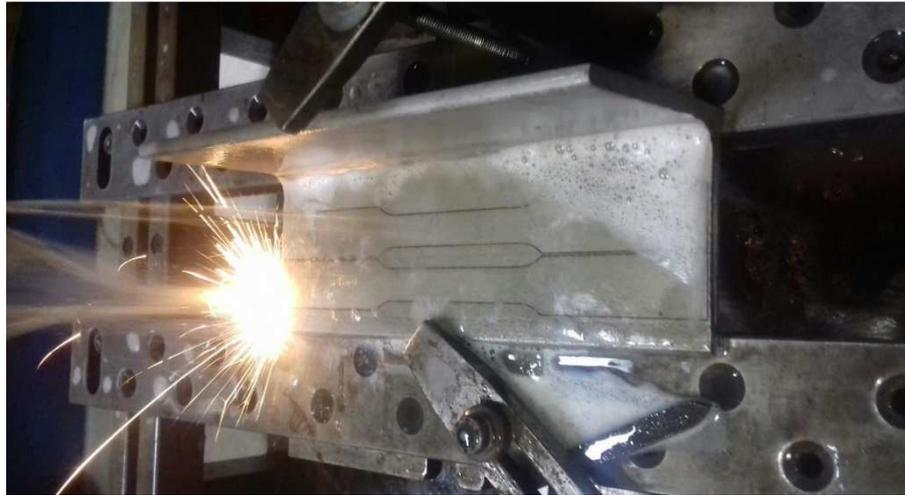
Figura 28 – Corte dos corpos-de-prova para cantoneiras em aço inoxidável.
