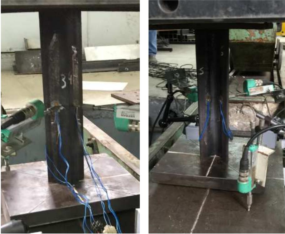
Figura 38 – Esquema do posicionamento dos LVDTs e dos extensômetros para os ensaios preliminares
