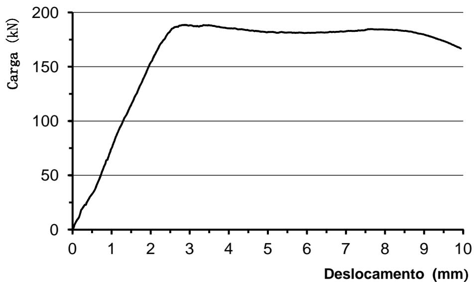
Figura E3 – Curva tensão *versus* deslocamentos LC\_51x51x4,8\_L750\_1
