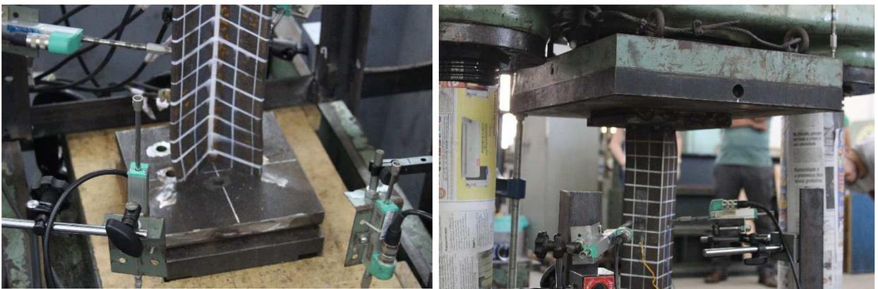
Figura 51 – Detalhe das extremidades da coluna LC\_76x76x6,4\_L750\_1
