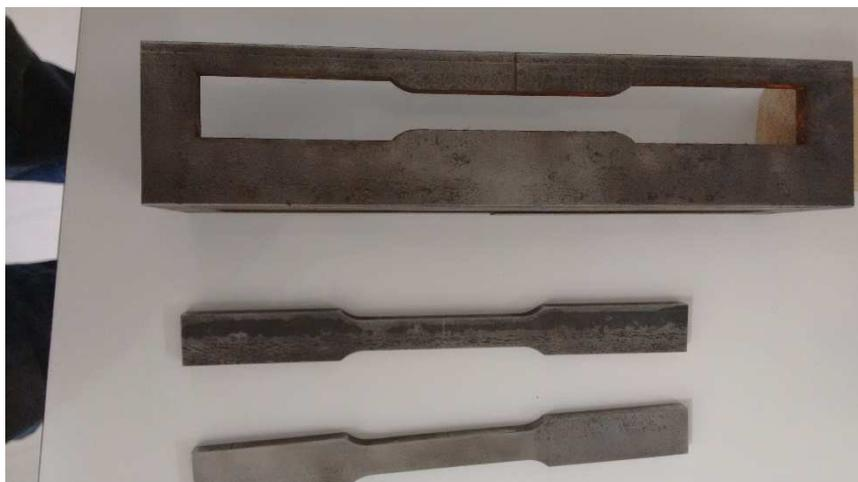
Figura 25 – Detalhe da extração de corpo-de-prova da cantoneira.
