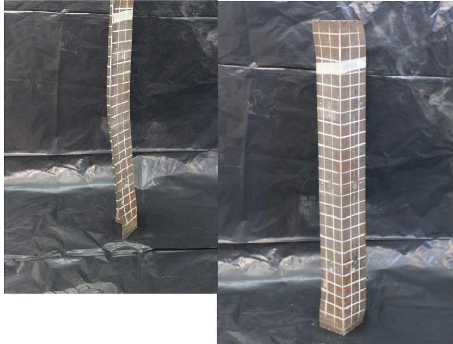
Figura 58 – Configuração deformada após o ensaio - coluna LC\_76x76x6,4\_L750\_2.
