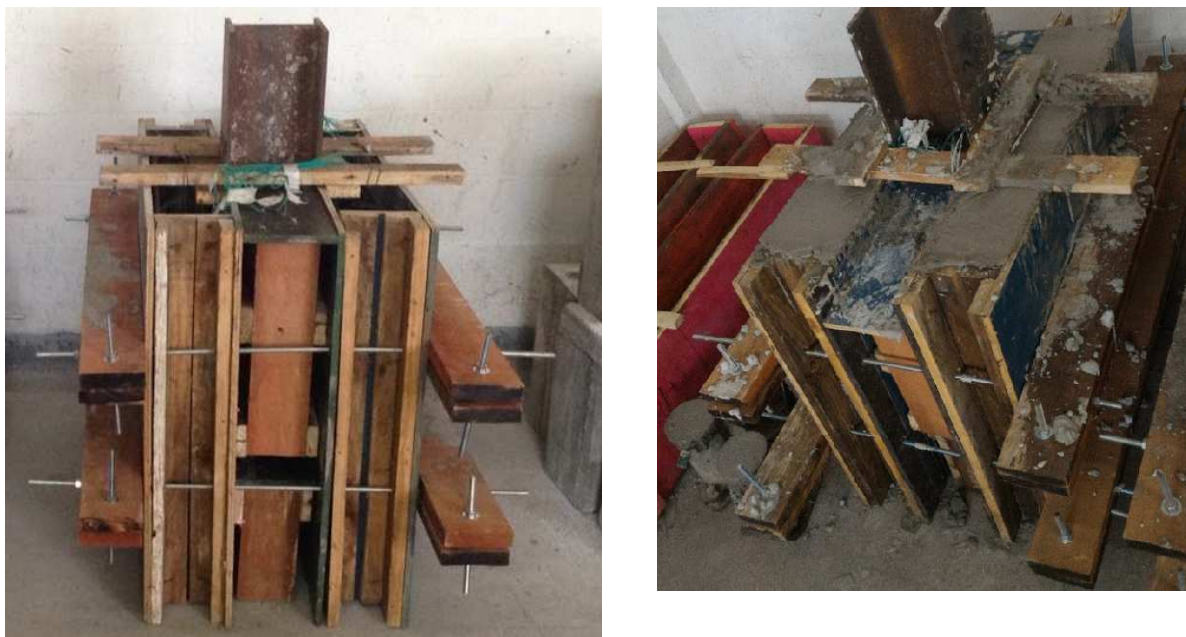
Figura 79 – Formas da concretagem – protótipos com conectores T-Perfobond inclinados
