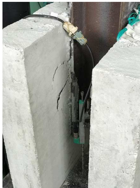
Figura 111 – Ruptura da laje TP
