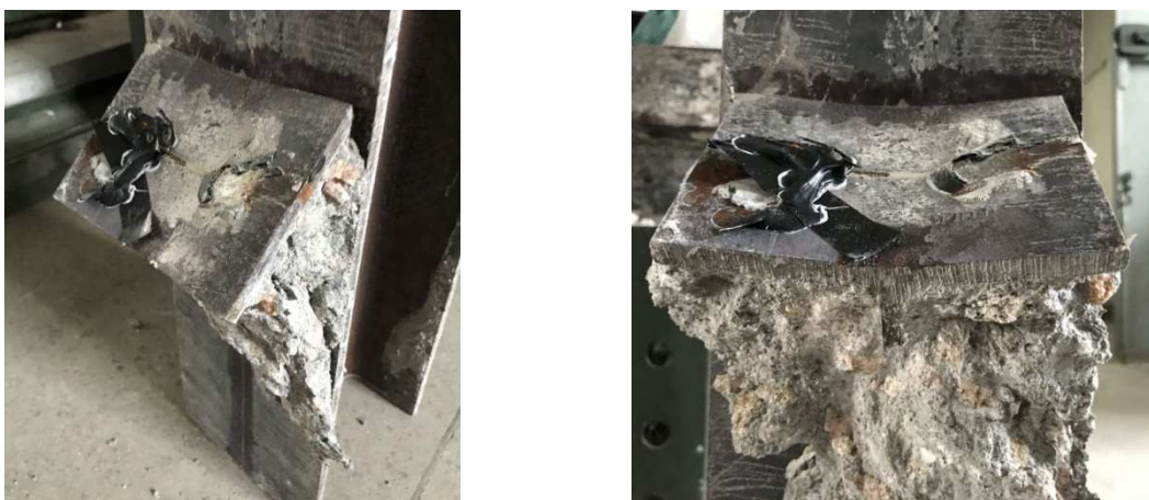
Figura 108 – Plastificação da mesa do conector – ensaios TP60
