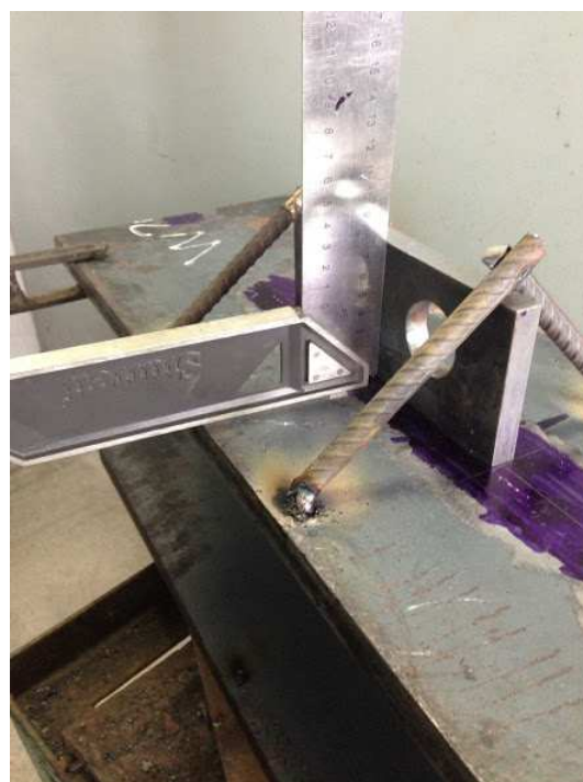
b) verificação de prumo dos conectores
