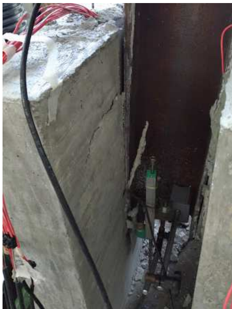
Figura 111 – Ruptura da laje TP
