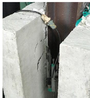
Ruptura da laje, TP
