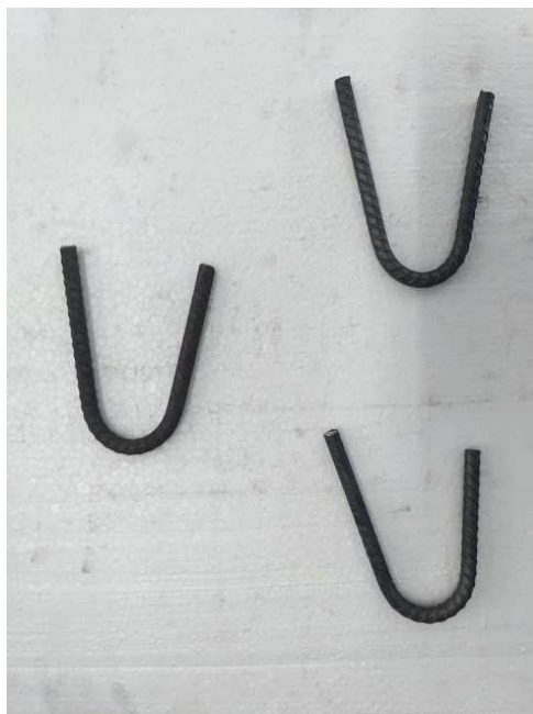
Figura 70 – Ensaio de dobramento da barras de aço
