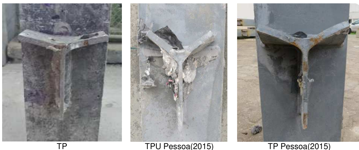
Figura 118 – Plastificação do Conector
