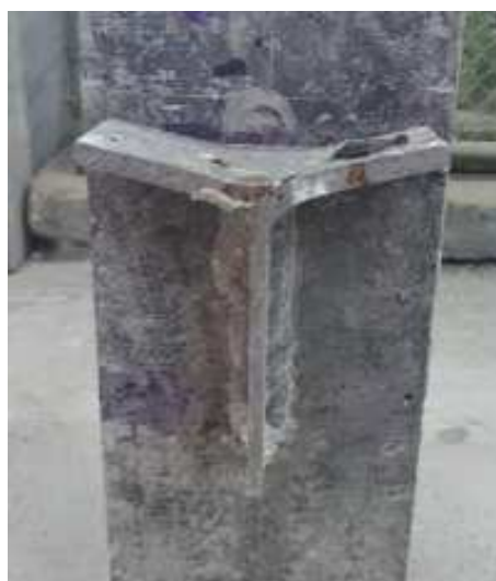
Figura 112 – Plastificação da mesa do conector TP
