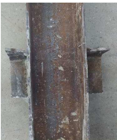
Figura 112 – Plastificação da mesa do conector TP
