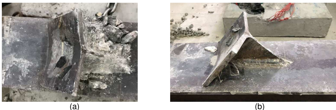
Figura 103 – Plastificação da mesa do conector – ensaios TP45
