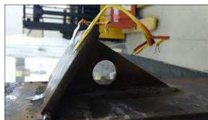
Figura 127 – Conector TP60 com furo
