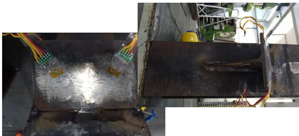
Figura 80 – Posição das rosetas – ensaios com conectores T-Perfobond inclinados
