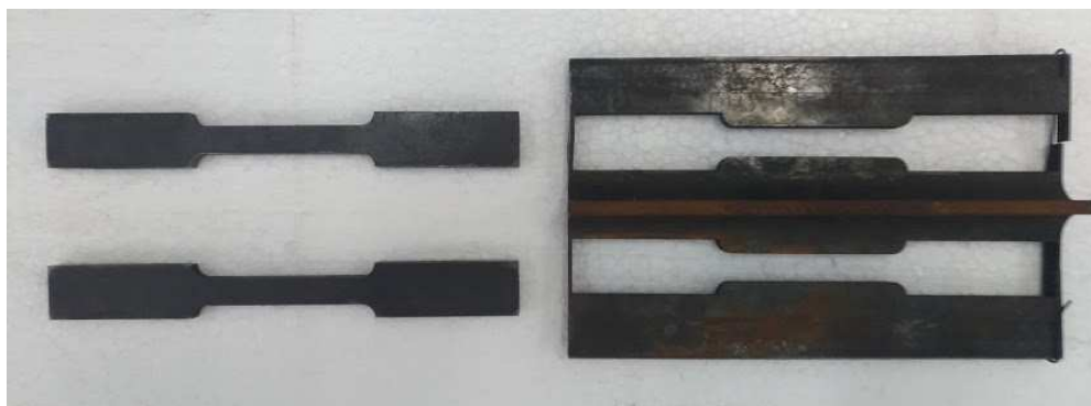
Figura 82 – Fabricação dos corpos de prova para ensaios a tração
