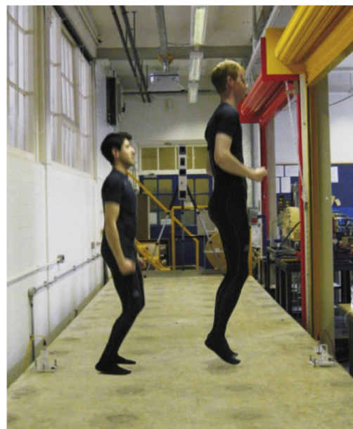
b) Saltos sobre uma laje de concreto
