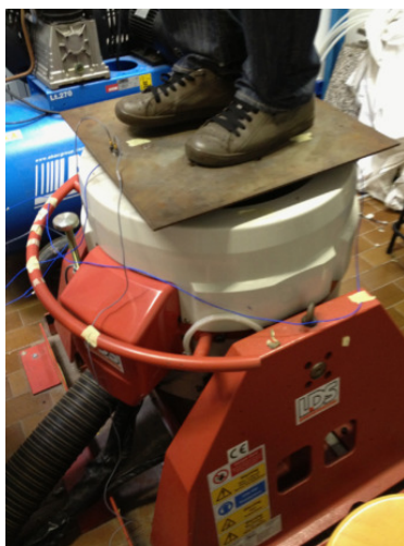
a) Pessoa sobre o conjunto plataforma de força-shaker (CAPPELLINI, 2015)
