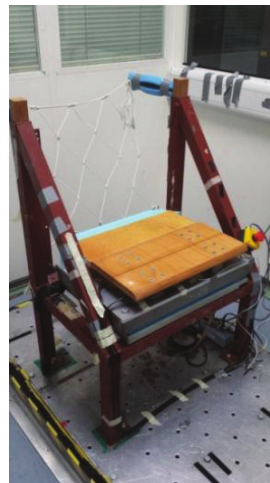
b) Vista do conjunto plataforma de força-shaker (LIU; QIU; GRIFFIN, 2017)
