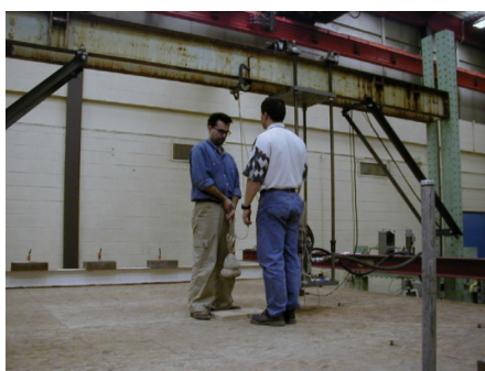
a) Ensaio de vibração livre com 2 indivíduos
