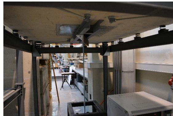
b) Detalhe da ligação shaker -laje
