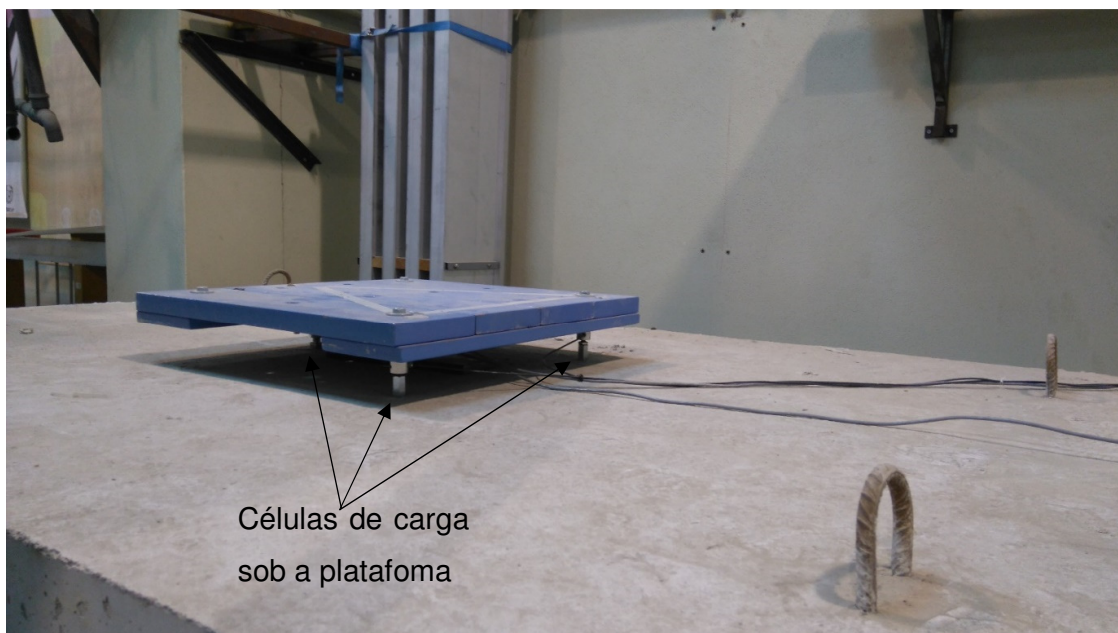
c) Placa instrumentada sobre o centro da laje
