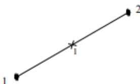
Figura 84: Elemento de treliça T3D2
