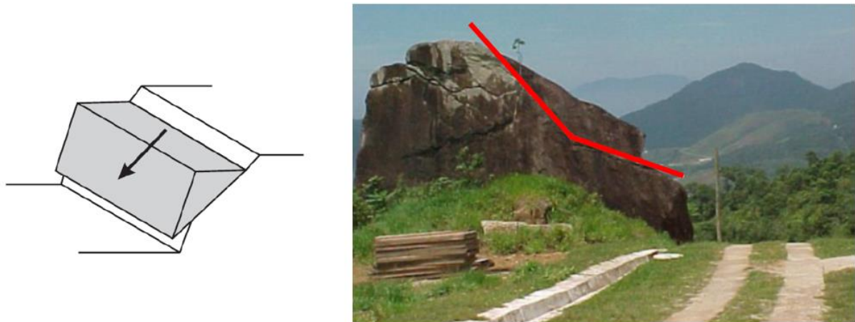
Figura 3 – Ruptura planar (Adaptado de Wyllie e Mah (2004) e Nunes (2004))
