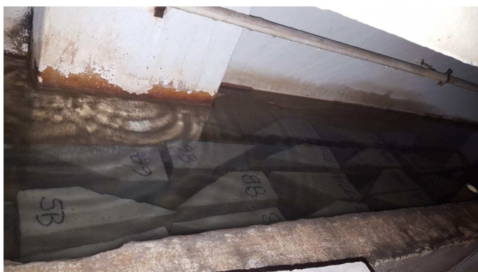
Figura 56 – corpos de prova durante a cura
