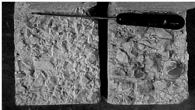
Figura 41 – Rugosidades obtidas 2 dias após a moldagem (Momayez et al., 2005).
