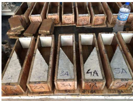
Figura 55 – detalhe das formas na segunda etapa
