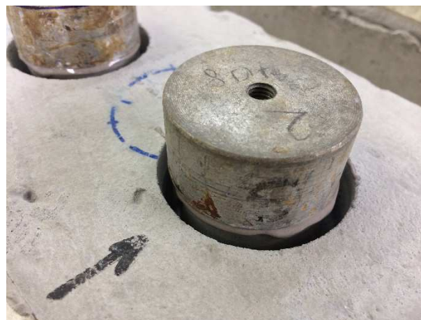
Figura 68 – Detalhe da colagem da pastilha
