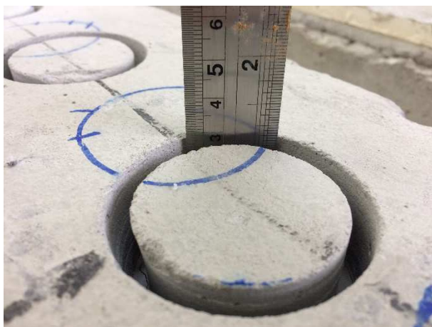
Figura 67 – Detalhe da profundidade do corte
