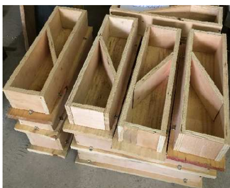
Figura 54 – formas de compensado naval utilizadas
