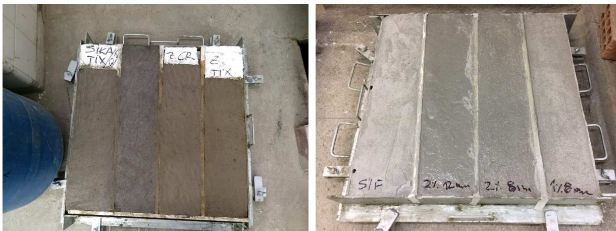
Figura 63 – placas com faixas de argamassas e compósitos
