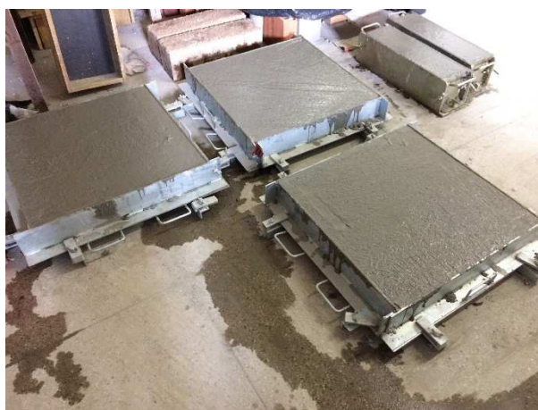
Figura 62 – corpos de prova preparados para o ensaio de arrancamento
