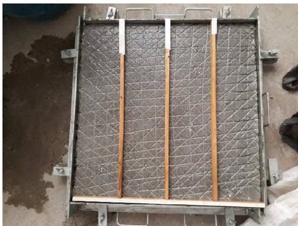
Figura 64 – detalhe da rugosidade da superfície
