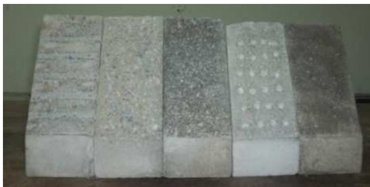
Figura 44 – Diferentes rugosidades testadas (Tayeh et al., 2003).
