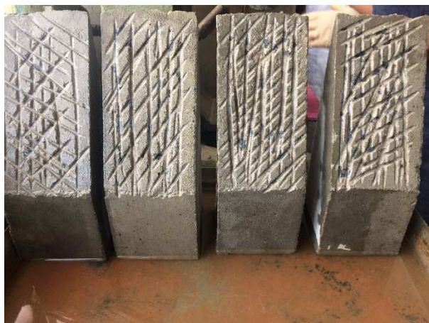
Figura 59 – Condição de umidade da interface
