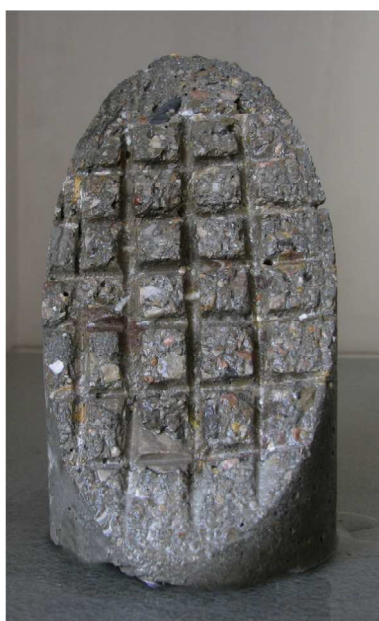
Figura 46 – Rugosidade obtida com ranhuras e aplicação de ácido (Mirmoghtadaei et al., 2015).
