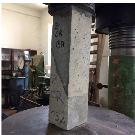
Figura 61 – detalhes do ensaio de cisalhamento oblíquo
