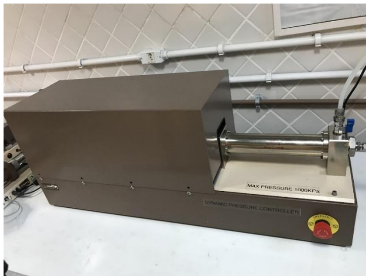
Figura 60 – Controlador Avançado de Pressão e Volume utilizado para pressão confinante
