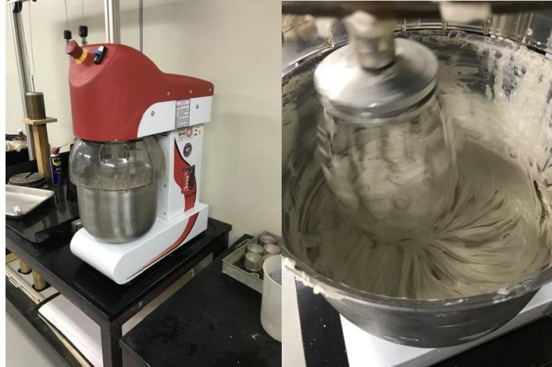
Figura 55 – Homogeneização do material na batedeira
