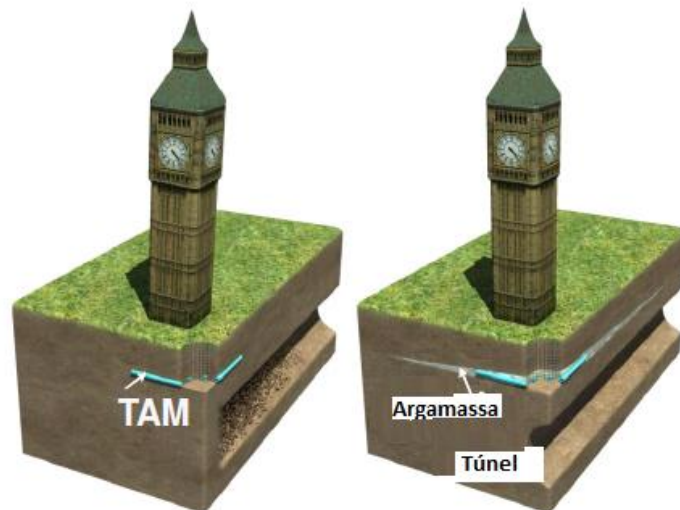
Figura 11 – Princípio do Compensation Grouting : argamassa injetada usando TAM para prevenção dos recalques que podem ocorrer devido a construções subterrâneas (Adaptado de Bezuijen, 2010)
