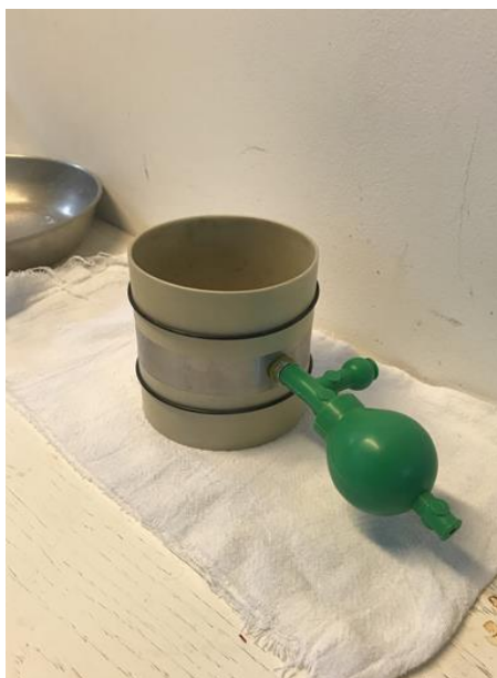
Figura 67 – Preparação da membrana de borracha no molde, removendo-se o ar por sucção
