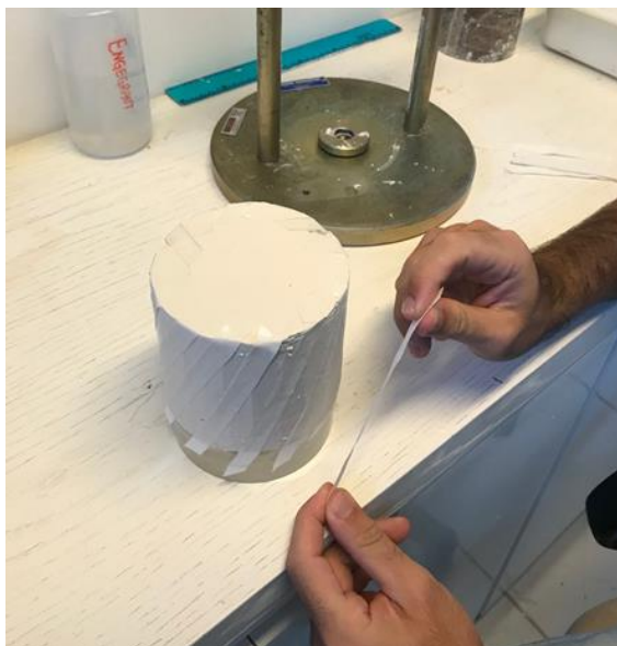
Figura 72 – Tiras de papel filtro colocadas na diagonal, possibilitando o adensamento radial
