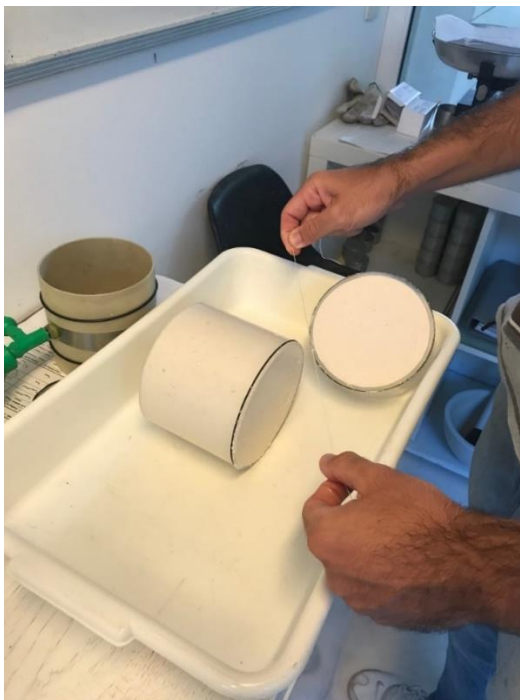
Figura 70 – Início da moldagem do corpo de prova. Retirada do colarinho do molde
