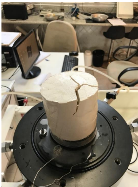
Figura 78 – Fraturas no topo do corpo de prova no momento da retirada do top - cap , pedra porosa e papel filtro ( R_s = 9,8\% )
