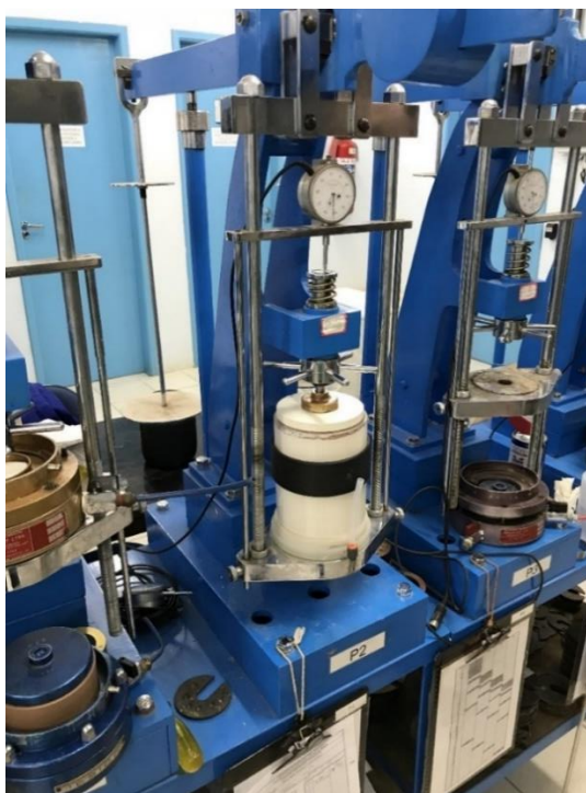
Figura 58 – Amostra na prensa de adensamento tipo Bishop
