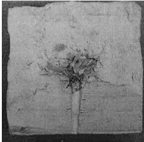
Figura 28- Injeção de cimento bentonítico ( a / c = 0,6 ) em amostra com OCR = 1 (Au, 2001)
