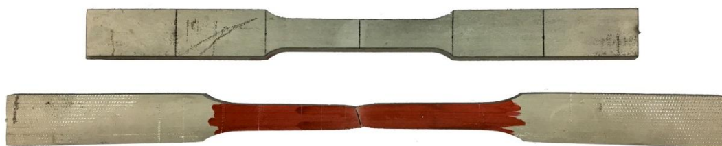
Figura 57 – Alongamento do aço inoxidável austenítico devido ao esforço de tração.
