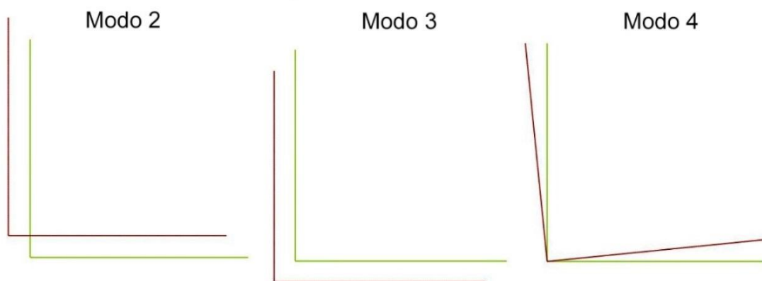
Figura 34 – Modos 2, 3 e 4 de deformação no programa GBTul.
