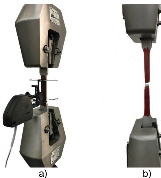
Figura 55 – Corpo de prova na máquina INSTRON 3382 a) no início do ensaio; b) após a ruptura.
