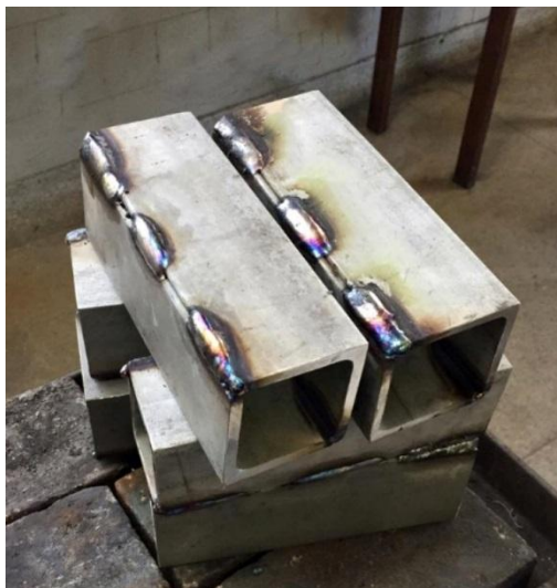
Figura 46 – Perfil tubular composto por dois perfis de cantoneiras soldados.
