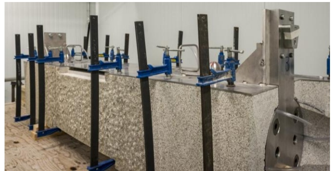
Figura 4 – Estrutura em aço inoxidável utilizada na catedral " La Sagrada Família " [5].
