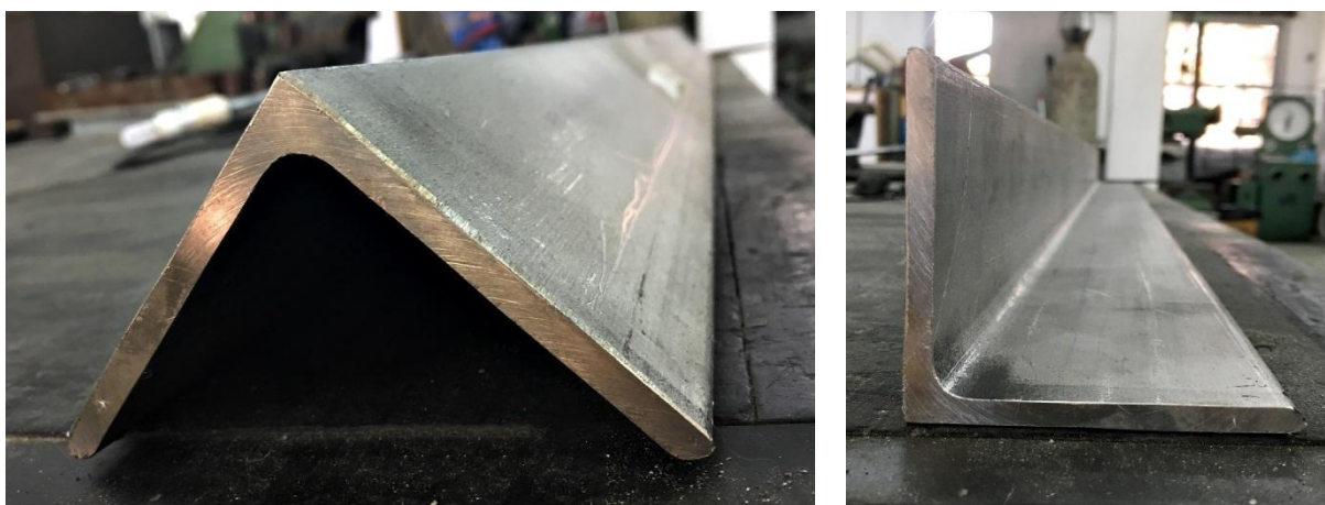
Figura 68 – Seção transversal após o processo de fresamento.
