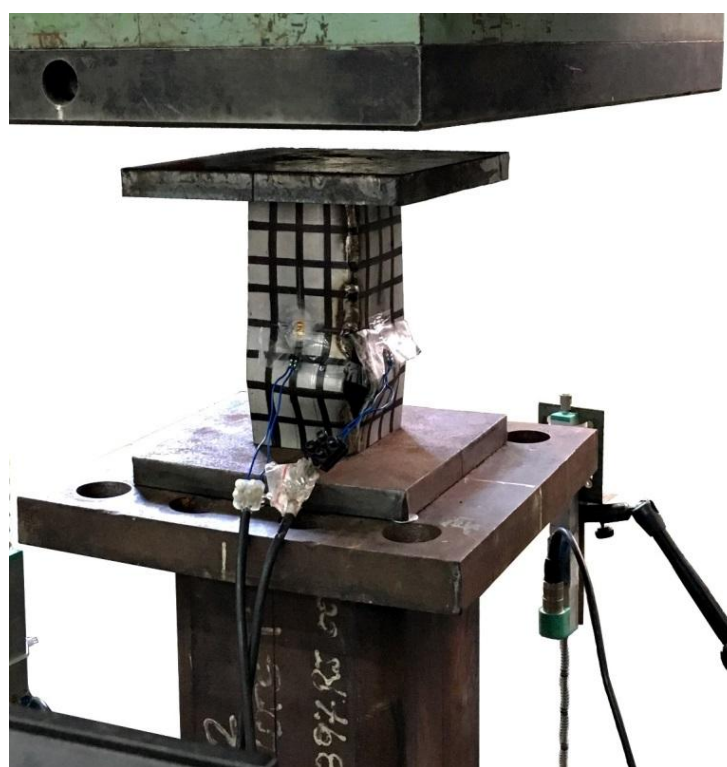
Figura 50 – Perfil tubular após o ensaio de caracterização a compressão.
