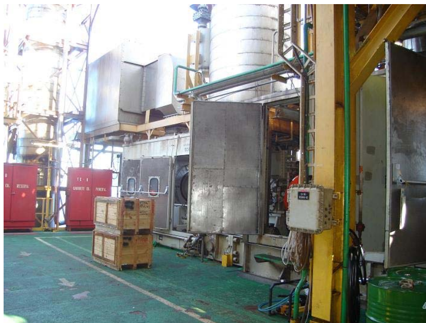
Figura 1 – Exemplo de turbo-compressor utilizado em plataformas offshore
