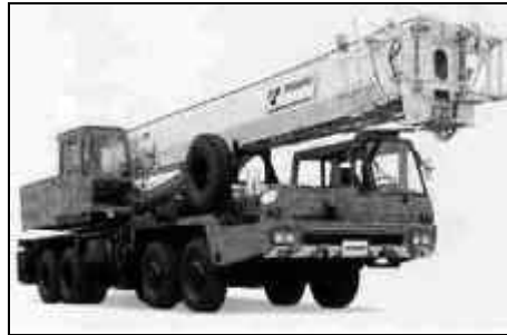
Figura 4.21 – Guindaste sobre chassi móvel de lança telescópica Fonte: Azevedo (2005 - trabalho em fase de conclusão)
