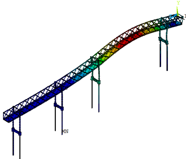
Figura 73 – Modos de vibração do Modelo III relativo à 6ª frequência natural f_{06} : 4,17 Hz.
