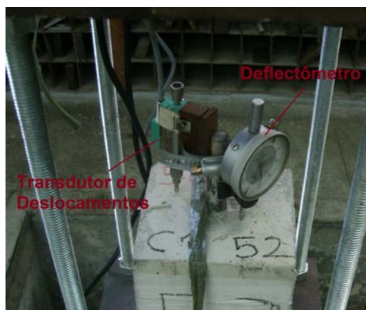
Figura 76 – Detalhe do Transdutor de deslocamentos acoplado e do defletoômetro analógico.
