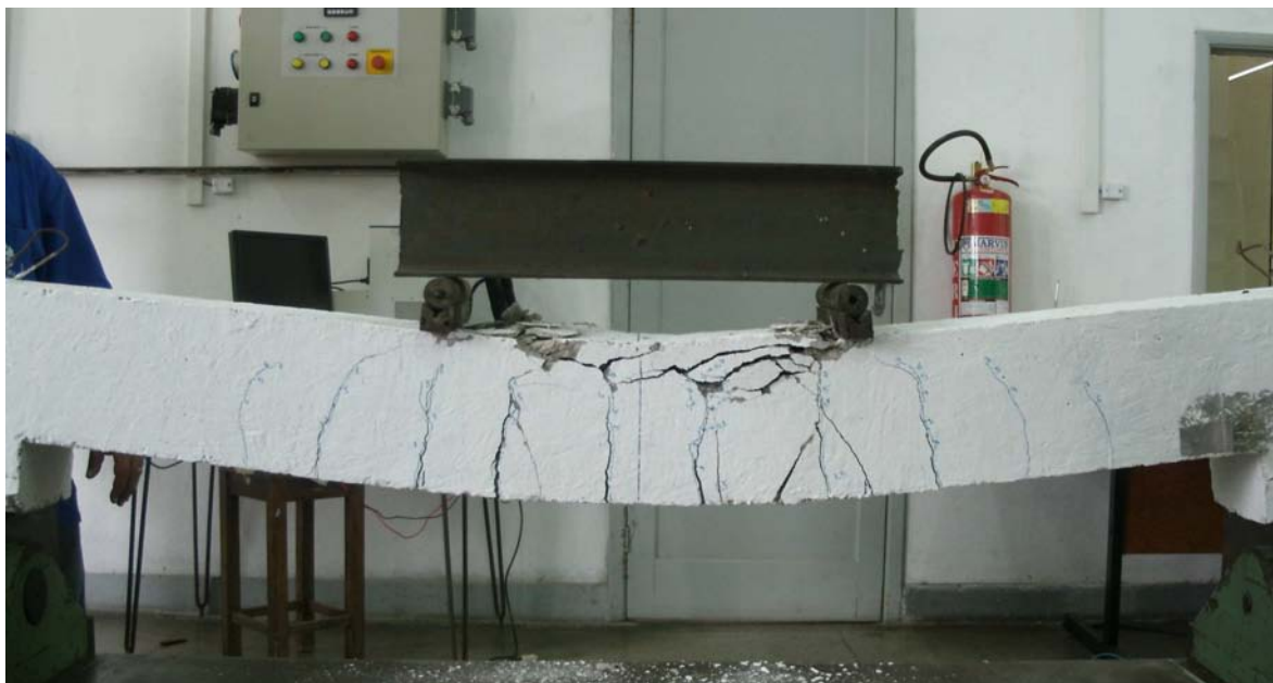
Figura 102 - Rompimento e fissuração da viga 1.
