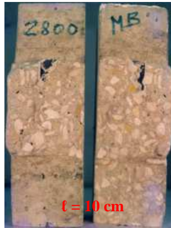
Figura 17 - Aspecto da ruptura do modelo CR - \varnothing = 12 \text{ mm} ( l = 10 \text{ cm} ), Souza (1990);
