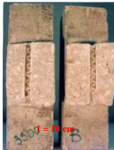
Figura 14 - Aspecto da ruptura do modelo CR - \varnothing = 8\text{ mm} ( l = 10\text{cm} ), Souza (1990);
