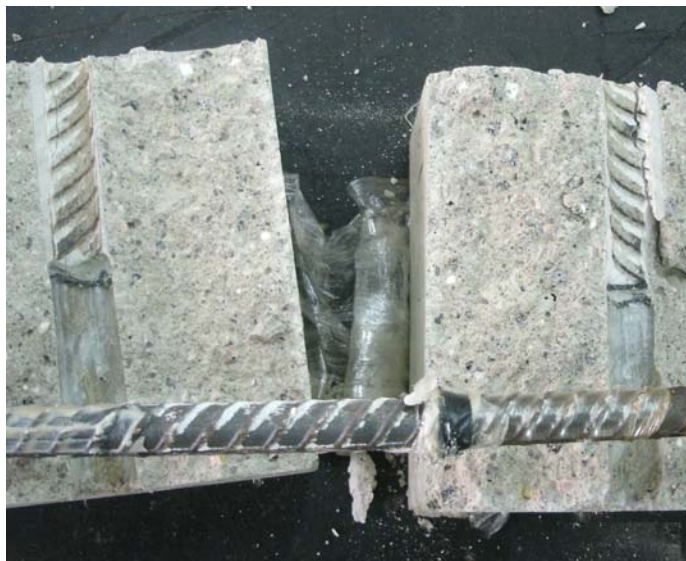
Figura 122 - Vista interna do comportamento e do trabalho realizado pela nervura da barra na resina
