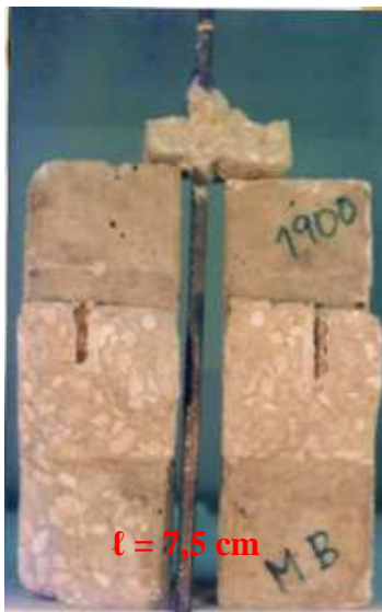
Figura 13 - Aspecto da ruptura do modelo CR - \varnothing = 8\text{ mm} ( l = 7,5\text{cm} ), Souza (1990);
