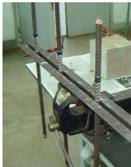
Figura 69 - Suporte de aço para colagem e fixação das barras aos blocos de concreto.
