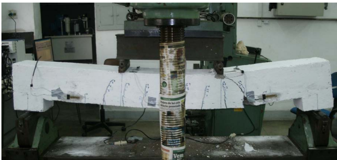
Figura 103 - Rompimento e fissuração viga 2.
