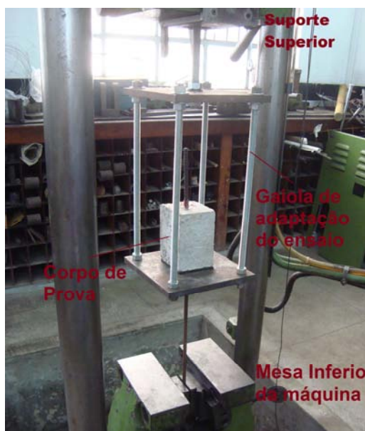
Figura 74 - Esquema do ensaio dos corpos de prova.
