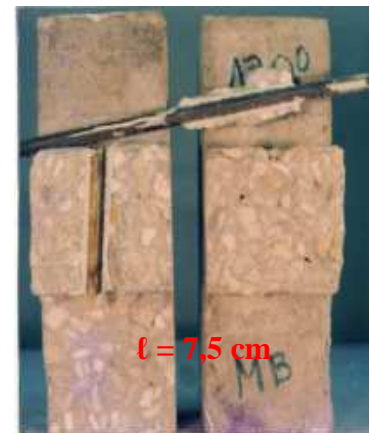
Figura 15 - Aspecto da ruptura do modelo CR - \varnothing = 8\text{ mm} ( l = 7,5\text{ cm} ), Souza (1990);
