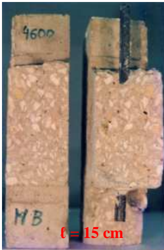
Figura 16 - Aspecto da ruptura do modelo CR - \varnothing = 12 \text{ mm} ( l = 15 \text{ cm} ), Souza (1990);
