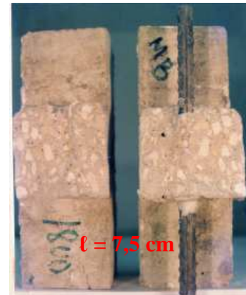
Figura 18 - Aspecto da ruptura do modelo CR - \varnothing = 12 \text{ mm} ( l = 7,5 \text{ cm} ), Souza (1990);
