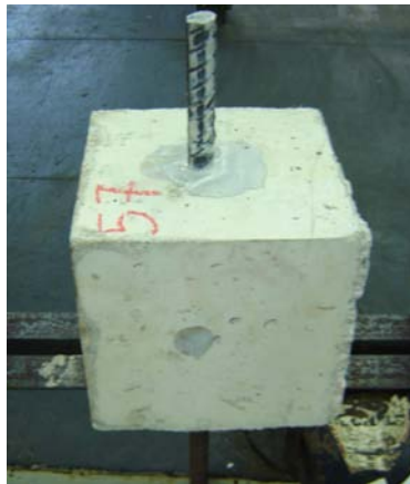
Figura 60 - Barra passante colada no furo previamente preenchido com resina.
