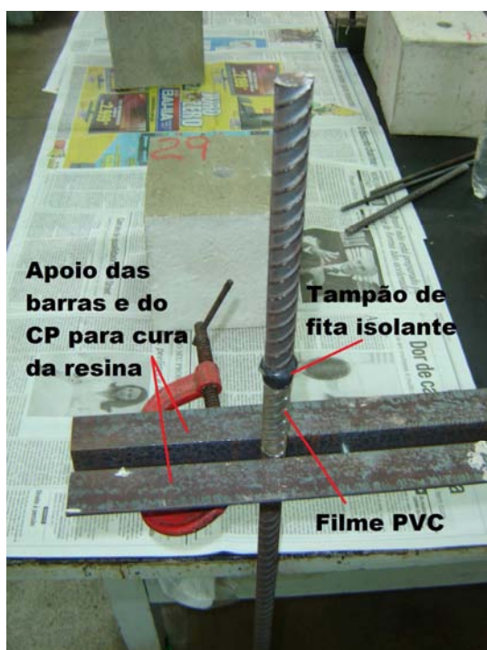
Figura 68 - Esquema da preparação barra de aço para a colagem-
