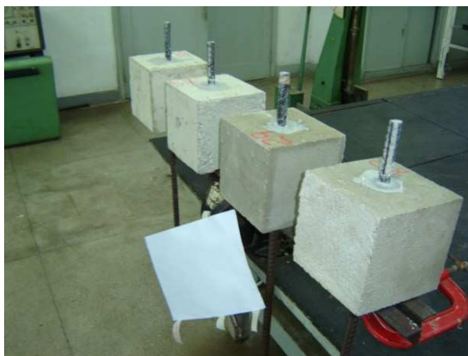
Figura 70 - Corpos de prova colados e apoiados.
