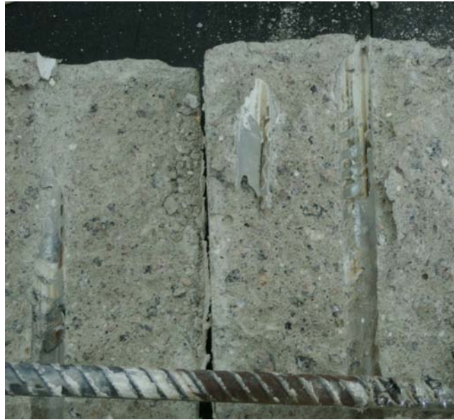
Figura 123 - Exemplo de bolhas ocasionando o escorregamento do aço mesmo nos modelos com resina.
