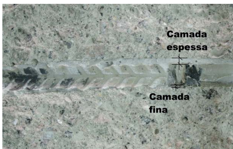
Figura 130 - Representação da camada de resina após colagem e rompimento.
