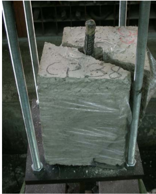
Figura 121 - Fendilhamento durante o ensaio de arrancamento do CP-38.
