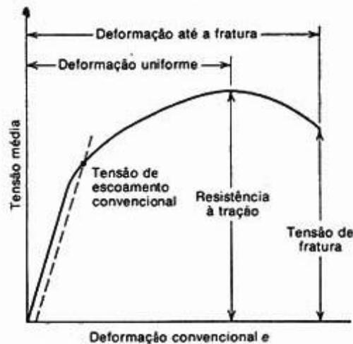
Figura 3.3 – Curva tensão *versus* deformação (DIETER, 1981)
