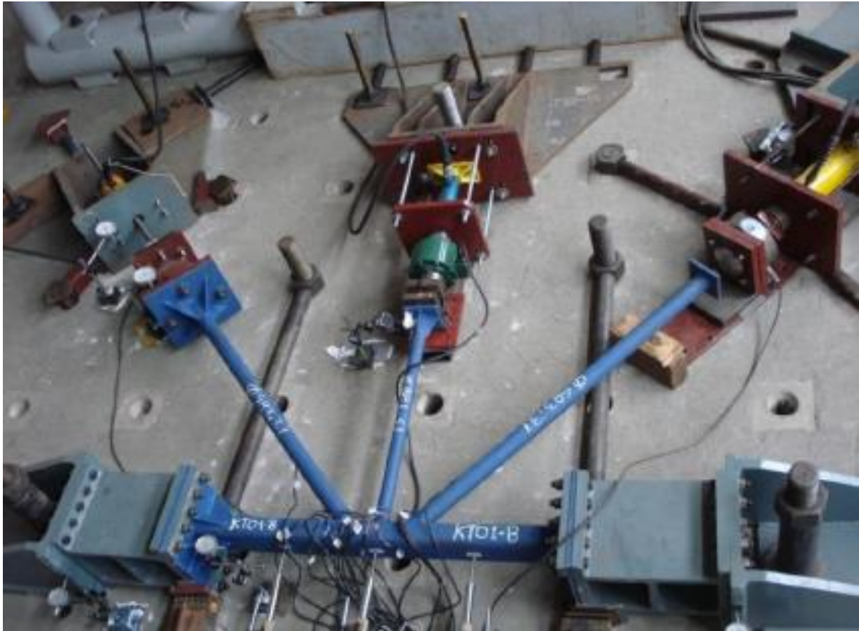
Figura 11 – Esquema geral do sistema de aplicação de carregamento [20]
