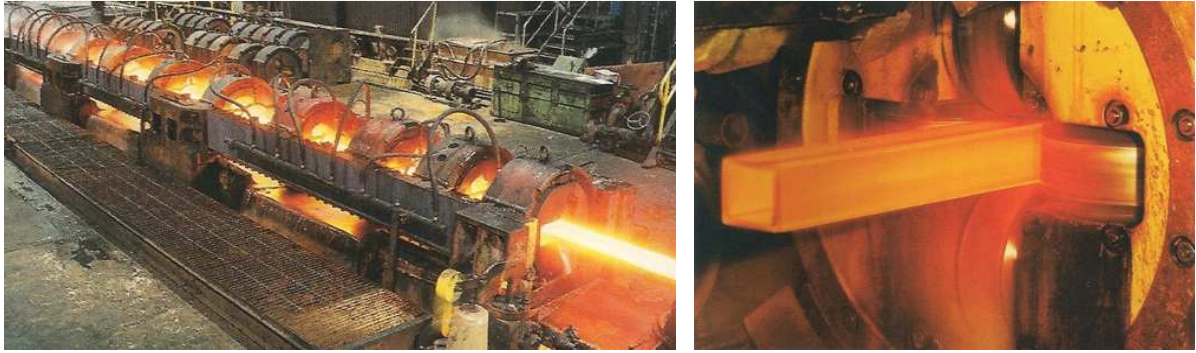
Figura 3 – Processo de fabricação de perfil RHS [9].
