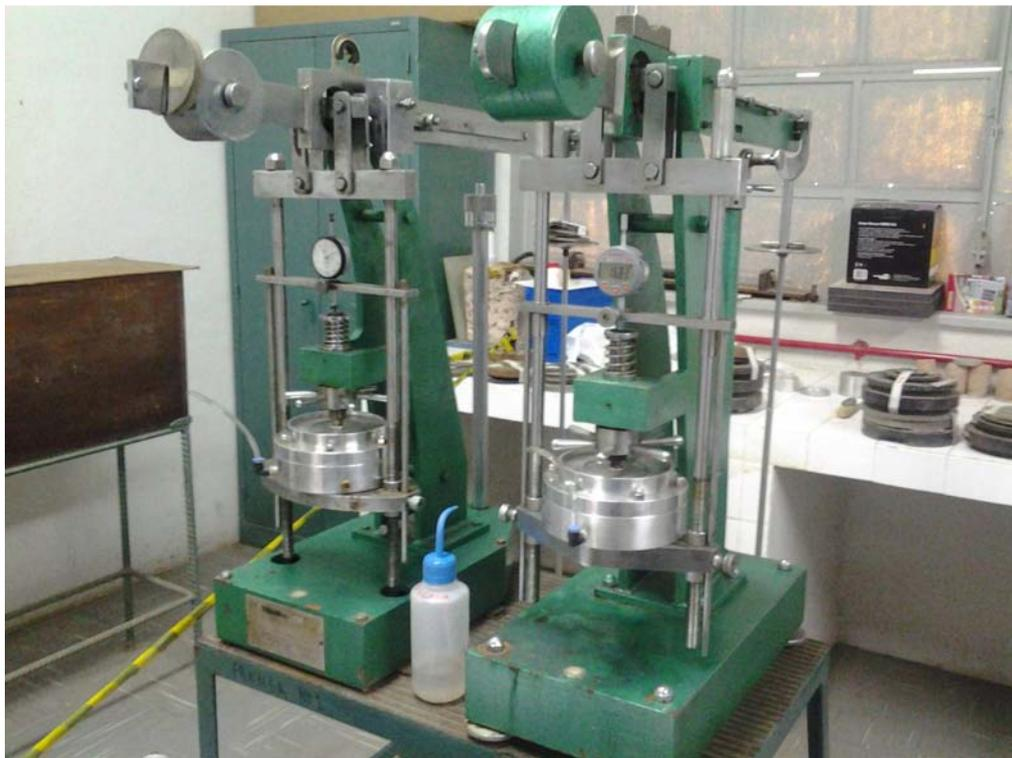
Figura 45 – Equipamento tipo Bishop para ensaio de adensamento incremental.
