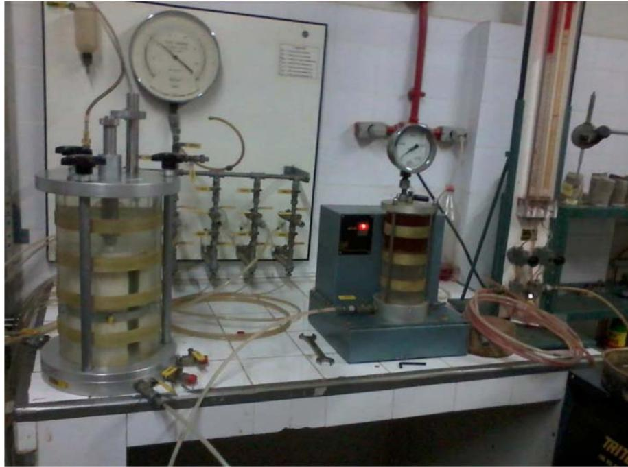
Figura 38 - Equipamento utilizado para aplicação de tensão confinante na mistura caulim-bentonita.
