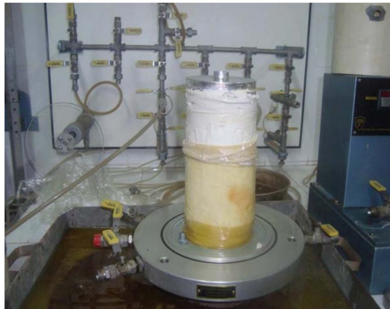
Figura 40 - Mistura caulim-bentonita após adensamento hidrostático.
