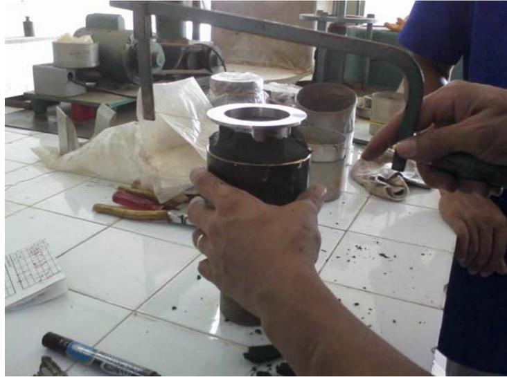
Figura 43 – Moldagem do corpo de prova (solo de Jacarepaguá).
