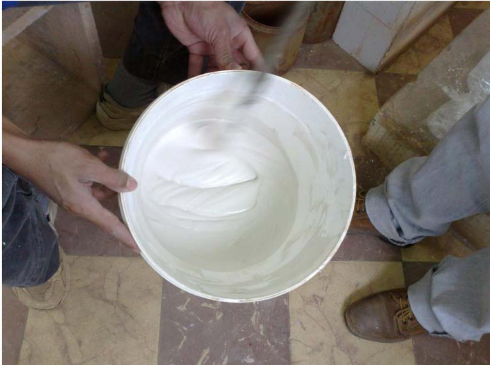
Figura 33 – Preparo da mistura de caulim e bentonita com adição de água destilada.
