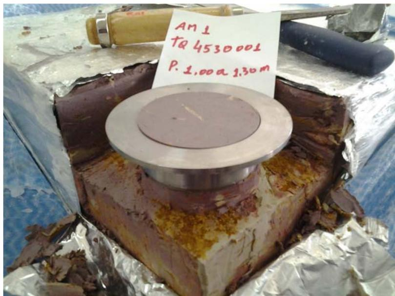
Figura 44 – Moldagem do corpo de prova (solo de Itaboraí).
