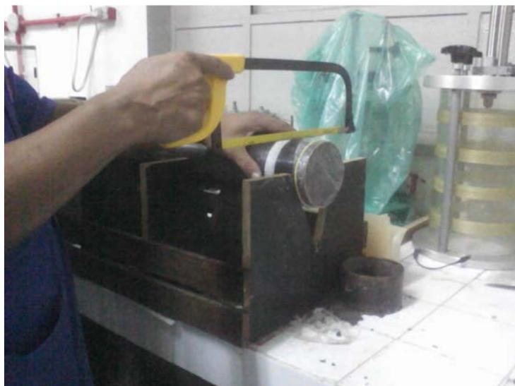
Figura 42 - Corte do tubo Shelby para extração dos corpos de prova (solo natural de Jacarepaguá).
