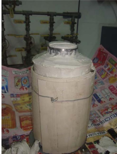
Figura 41 - Preparação do corpo de prova com cravação de anel (mistura caulim-bentonita).
