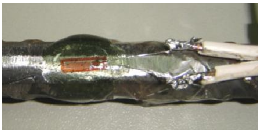
Figura 27 – Detalhe do extensômetro colado na armadura, (SOUZA, 2007)
