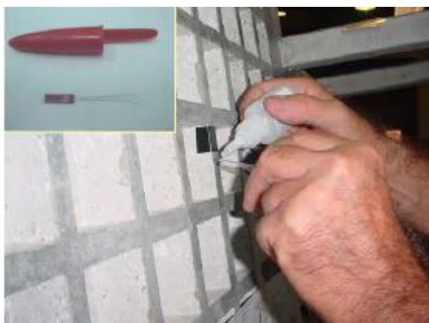
Figura 25– Detalhe da colagem dos extensômetros (SCHWETZ, 2005)
