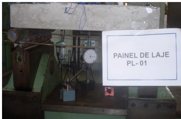
Figuras 126– Detalhe dos defletômetros e dos transdutores posicionados
