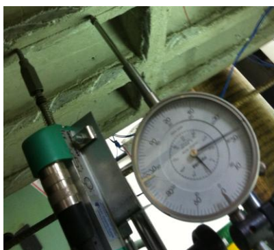
Figuras 128 – Detalhe de transdutor ao lado de defletômetro utilizado no ensaio de PL-02
