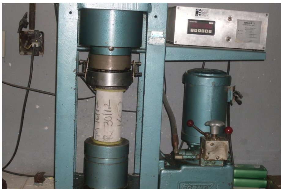
Figura 90 – Corpo de prova durante o ensaio de compressão axial
