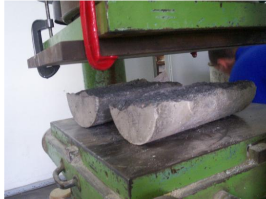
Figuras 86 e 87 – Corpos de prova durante e após o ensaio de compressão diametral
