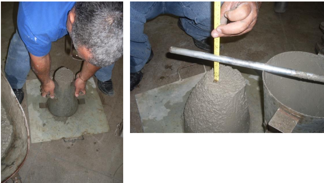
Figuras 75 e 76 – Realização de “slump test” no concreto de PL-01 e PL-02
