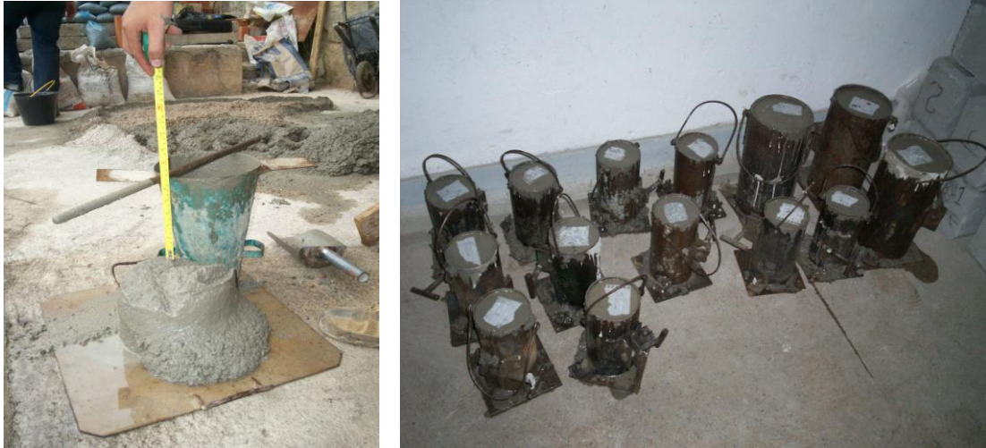
Figuras 63 e 64 – Ensaio de abatimento e corpos de prova moldados para elementos dos modelos I e II
