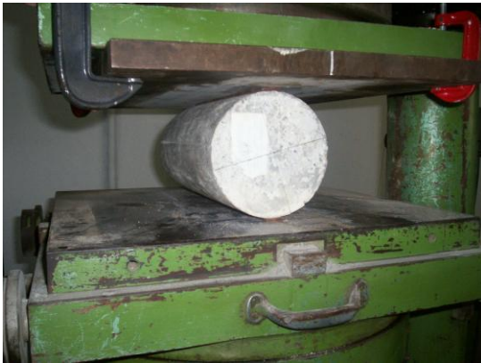
Figuras 86 e 87 – Corpos de prova durante e após o ensaio de compressão diametral
