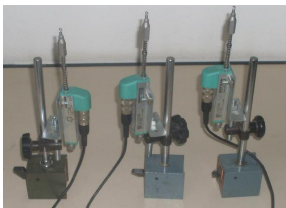
Figuras 121 – Detalhe dos transdutores utilizados nos ensaios
