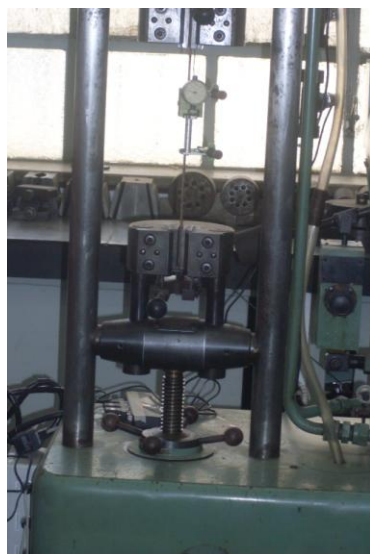
Figuras 92 e 93 – Ensaio de tração do aço
