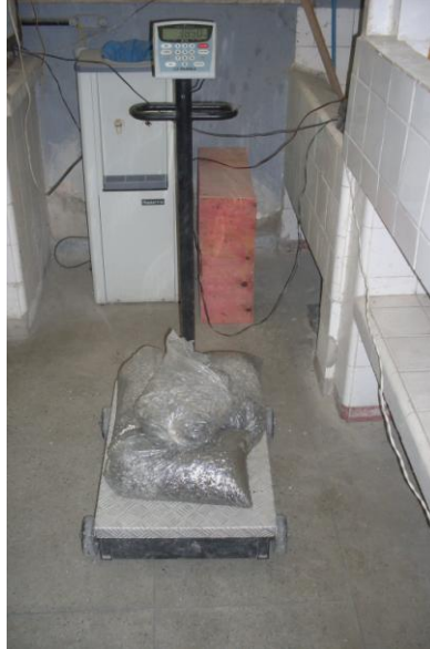
Figura 74 – Dosagem da brita usada no concreto de PL-01 e PL-02
