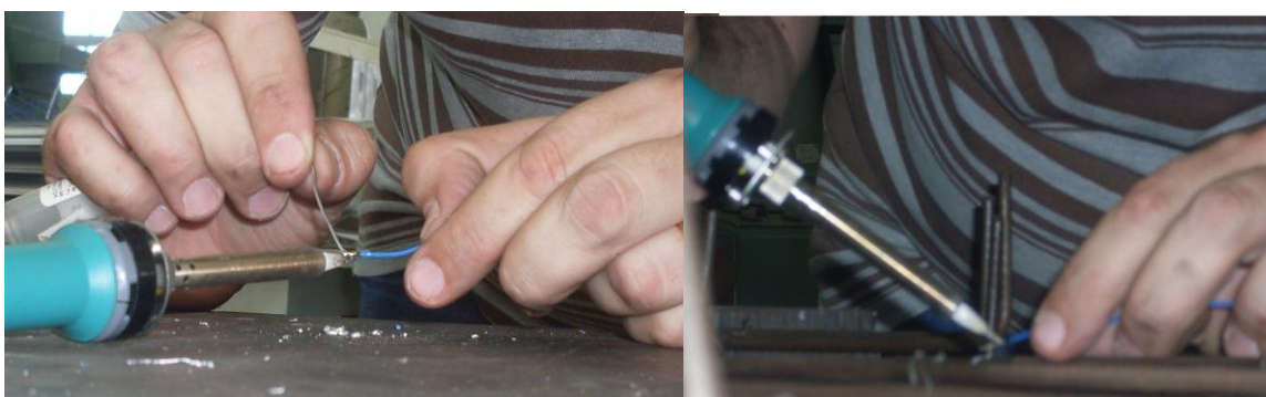
Figuras 110 e 111 – Detalhe do preparo da extremidade de fio e soldagem
