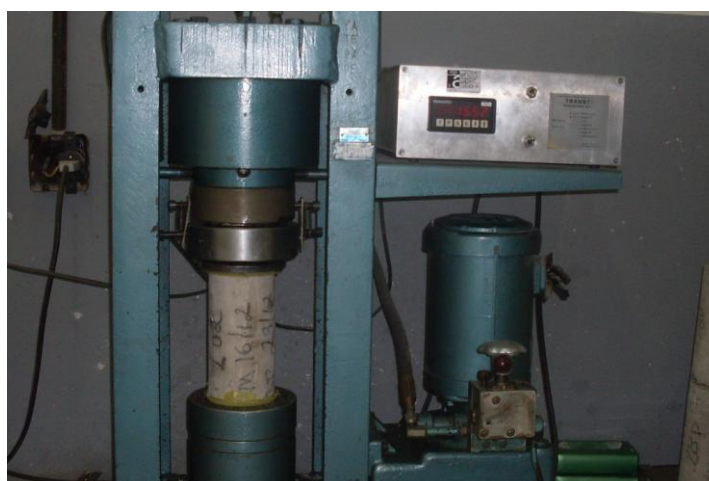
Figura 94 – Corpo de prova durante o ensaio de compressão axial
