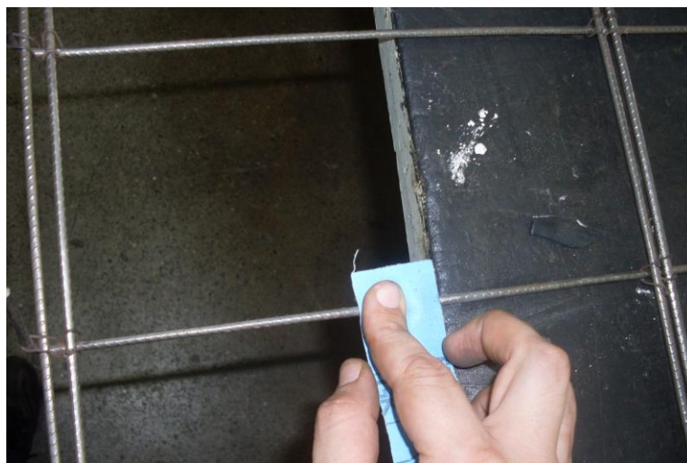
Figura 103 – Preparo de superfície do aço para colagem de extensômetro
