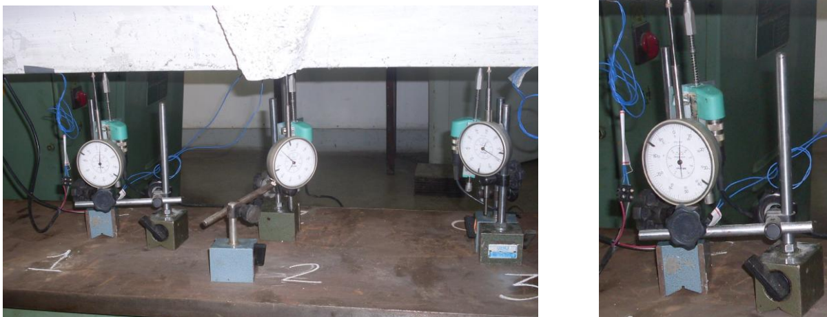
Figuras 123 e 124 – Detalhe dos defletômetros e dos transdutores utilizados nos ensaios das vigas
