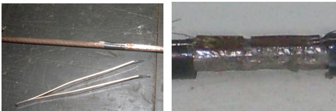
Figura 108 e 109 – Strain gage fixado sobre armadura
