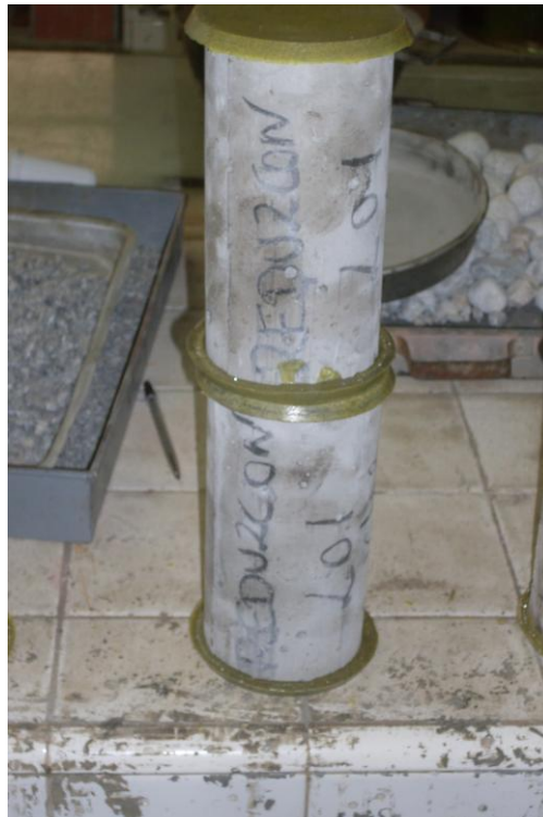
Figura 89 – Corpo de prova revestido com enxofre
