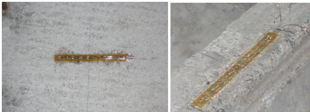
Figuras 105 e 106 – Strain gage colado sobre a superfície do concreto de V- 2A e PL-01
