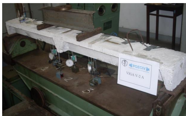
Figuras 140 – Viga V-2A antes do ensaio
