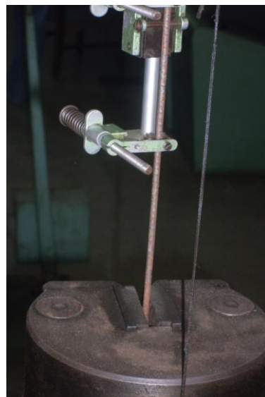
Figuras 92 e 93 – Ensaio de tração do aço
