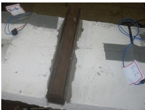
Figura 136 – Aspecto do ajuste no ponto de aplicação das cargas
