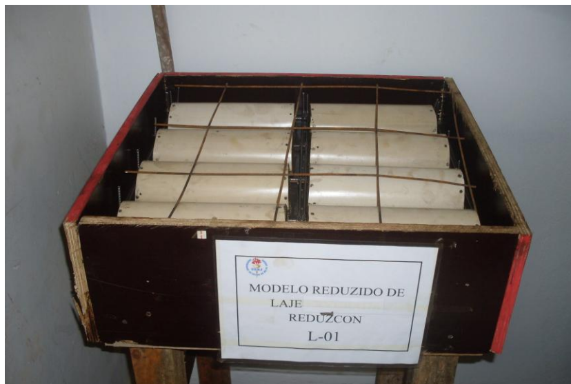
Figura 69 – Aspecto da fôrma PL-01
