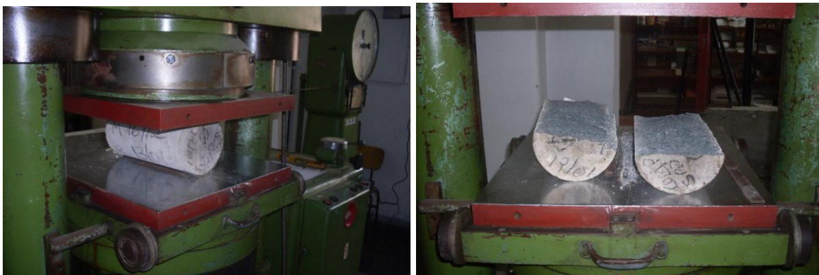
Figuras 95 e 96 – Corpo de prova durante e após o ensaio de compressão diametral
