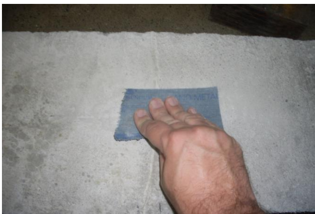
Figura 101 – Preparo de superfície de concreto para colagem de extensômetro
