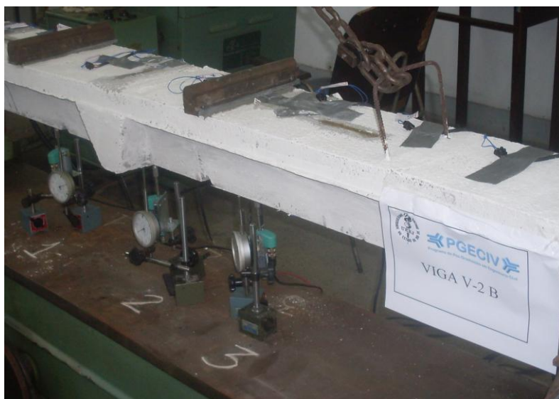
Figura 154 – Detalhes da posição de defletômetros e transdutores na Viga V-2B
