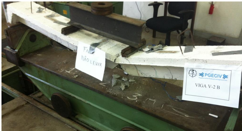
Figura 168 – Aspecto de V-2B após o término do ensaio
