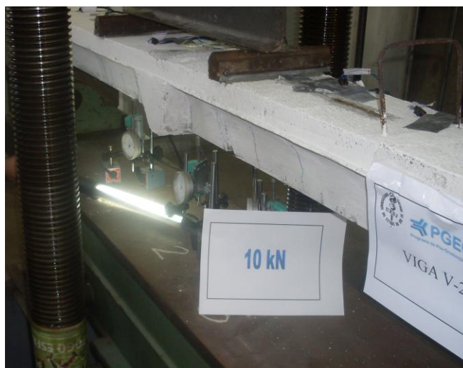
Figura 164 – Detalhes da carga com o aparecimento de fissuras na Viga V-2B
