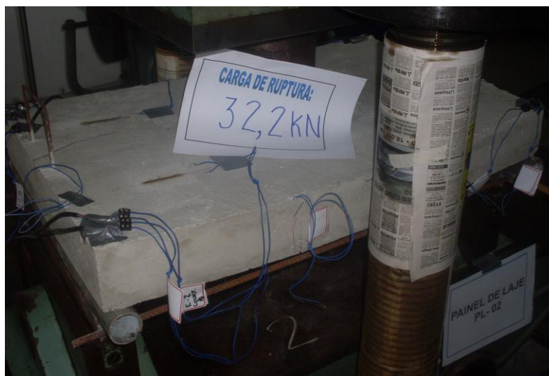
Figura 203 – Aspecto geral de PL-02 após a ruptura.
