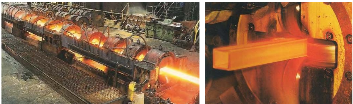
Figura 5 – Processo de fabricação de perfil RHS [4].
