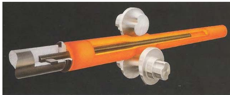
Figura 8 – Processo de laminação de Pilger [5].
