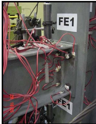
Figura 3.3 – Ligações com placa de extremidade ajustada (Lima, 2003)
