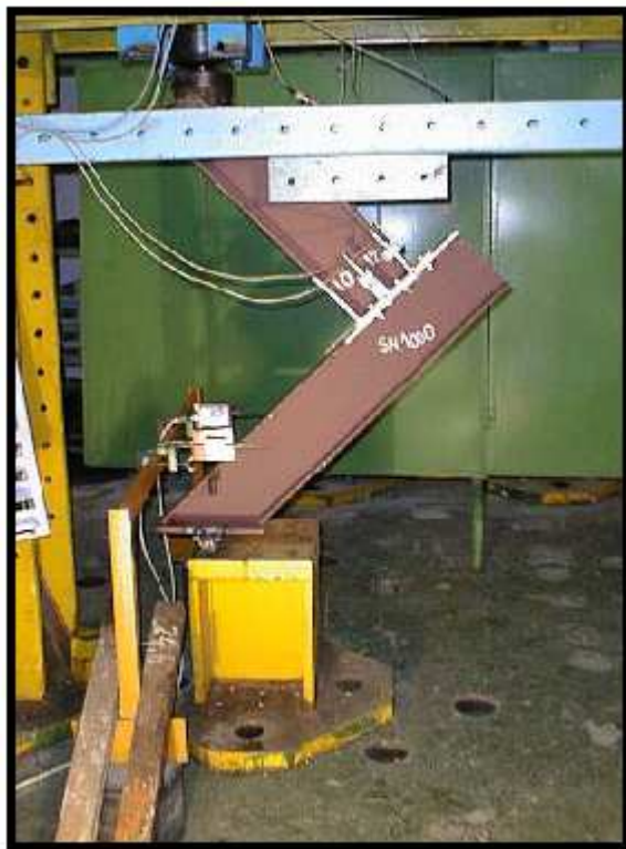
(a) placa de extremidade estendida (SN1000)
