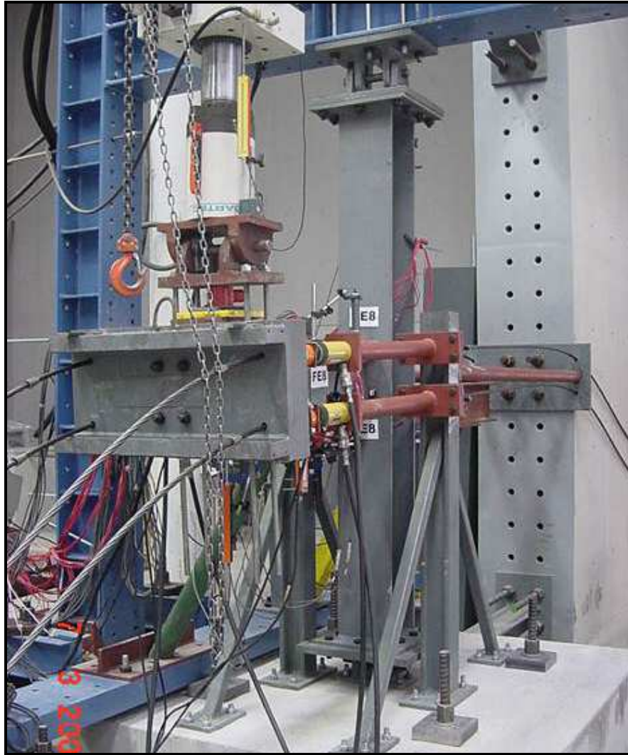
Figura 3.6 – Pórtico de aplicação da carga
