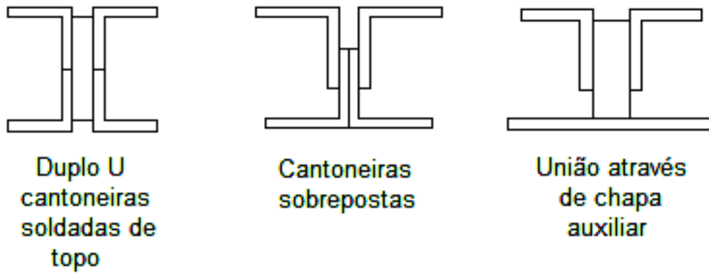
Figura 3.10 - Detalhe do apoio - vide Figura 3.8 [58]
