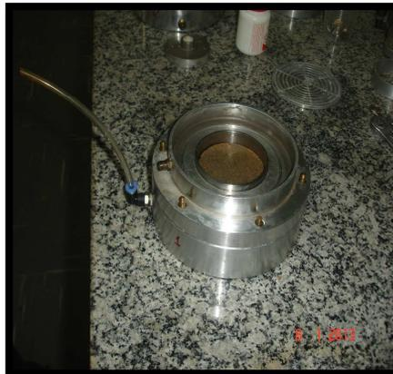
(b) colocação da pedra porosa na célula para ensaio SIC.
