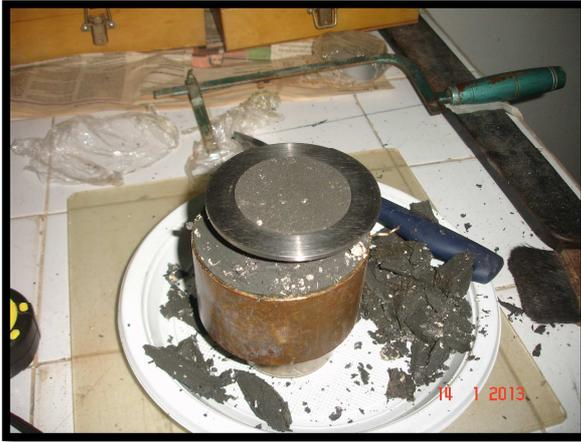
(a) Cravação do anel do corpo de prova fora do eixo da amostra.
