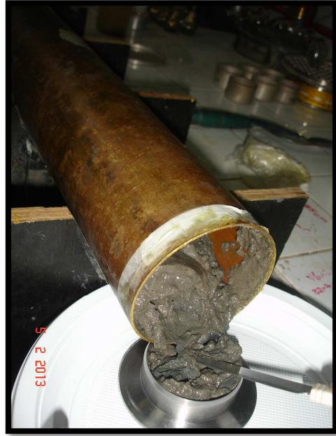
(b) Moldagem do corpo de prova amolgado.
