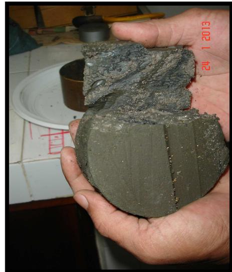
(d) Fissuras na amostra V5B 1.
