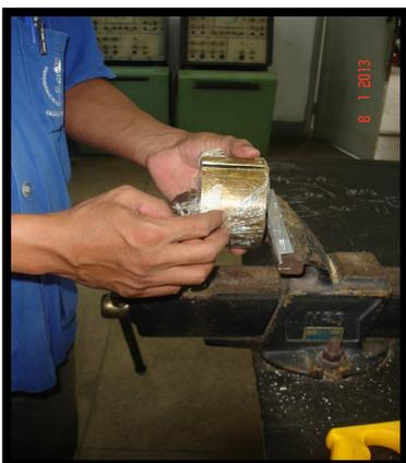
(d) separação da amostra e a parede do Shelby.
