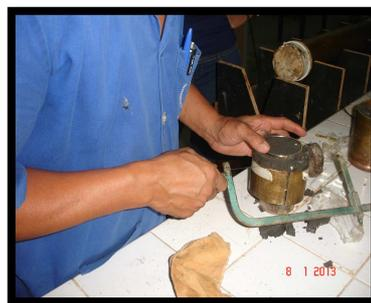
(e) utilização de suporte com diâmetro pouco inferior para extração da amostra.
