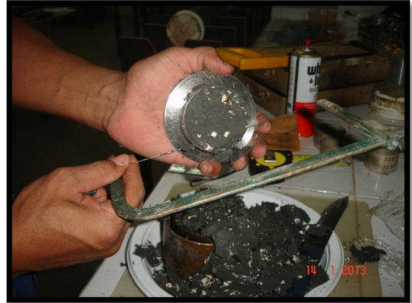
(b) Dificuldades na moldagem do corpo de prova.
