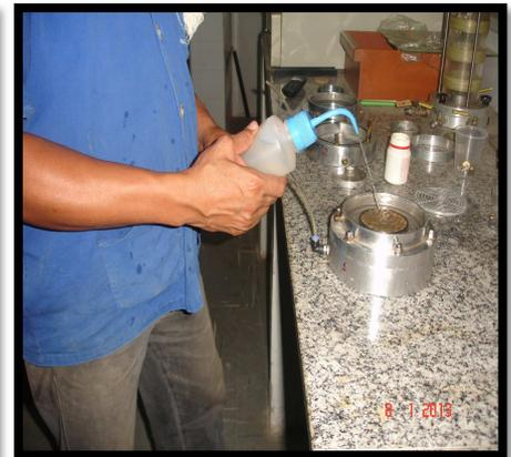
(c) saturação da célula após colocação do corpo de prova.
