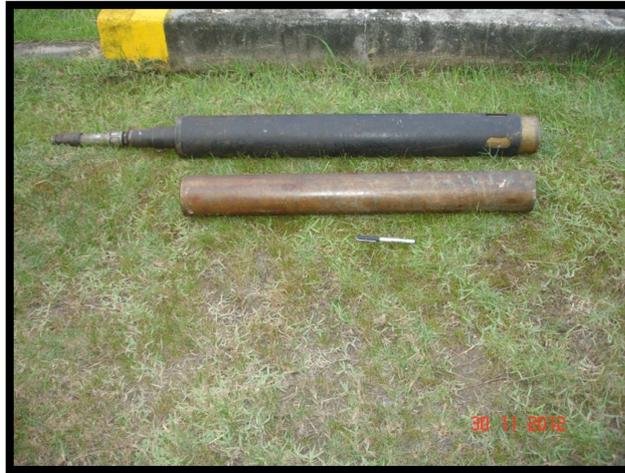
Figura 37 – Amostrador Osterberg e tubo Shelby utilizado na retirada das amostras.
