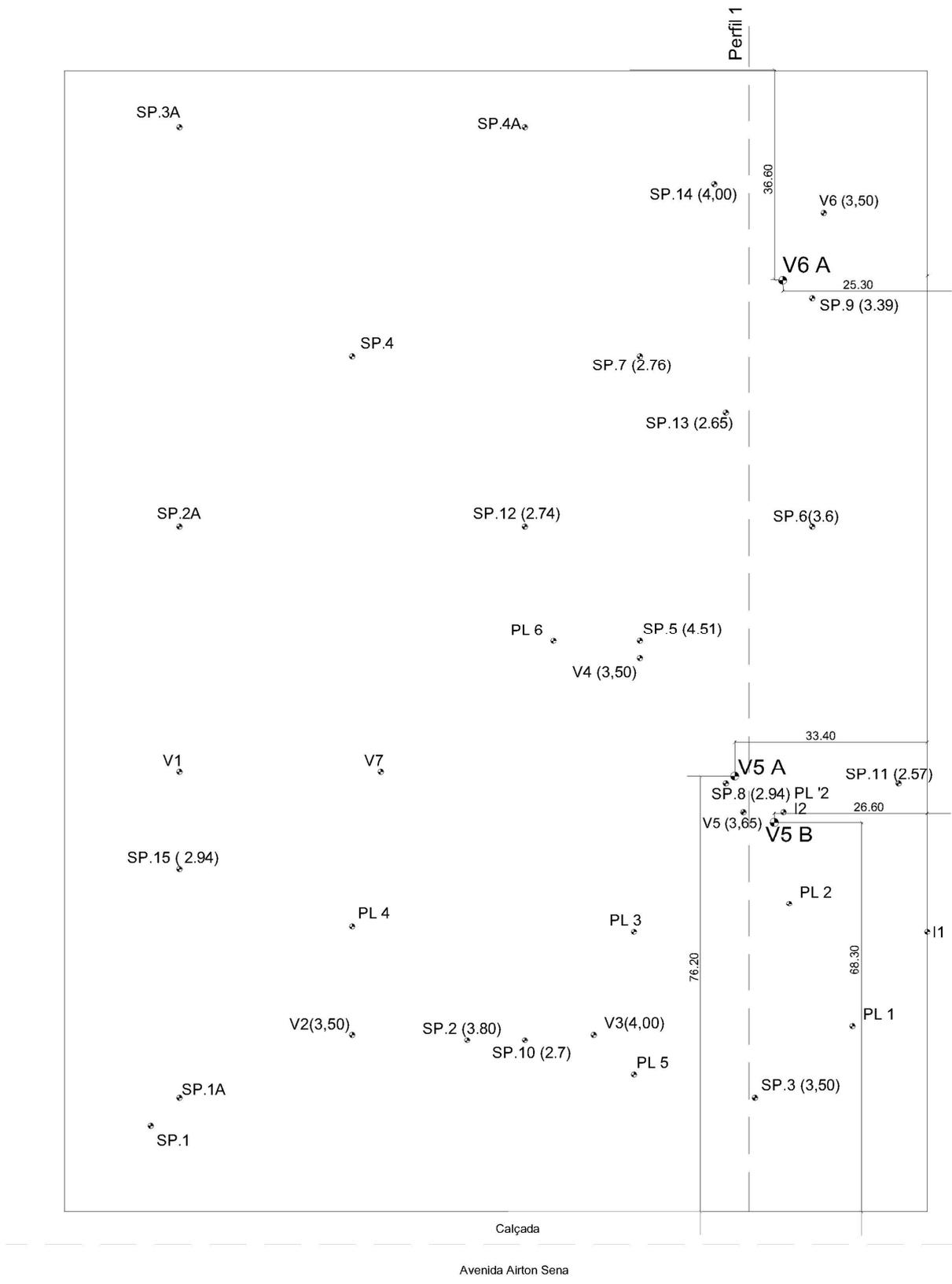
Figura 36 – Locação das verticais V5A, V5B e V6A de amostragem indeformada para a campanha de ensaios após a manutenção do aterro por 15 anos.
