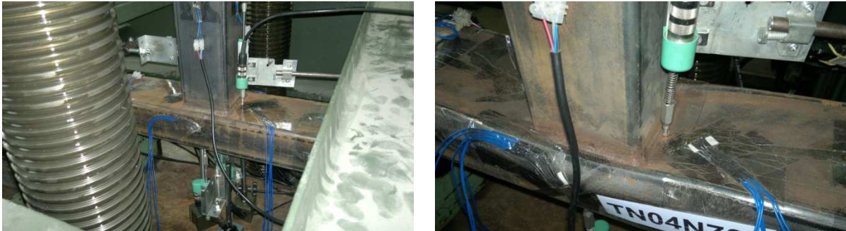
a) Detalhe do posicionamento dos dispositivos de leitura de deslocamentos
