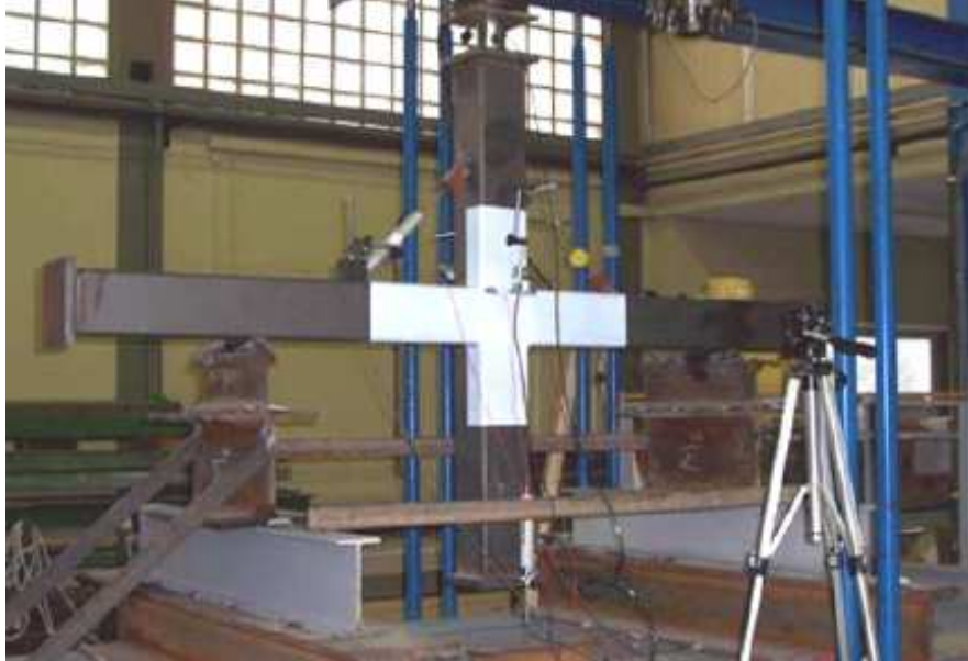
Figura 19 – Imagem do modelo ensaiado por Christitsas et al. [18].
