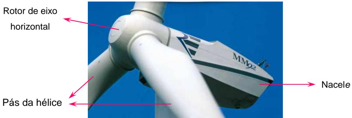
Figura 18 – Parte superior do modelo MM92 [21].
