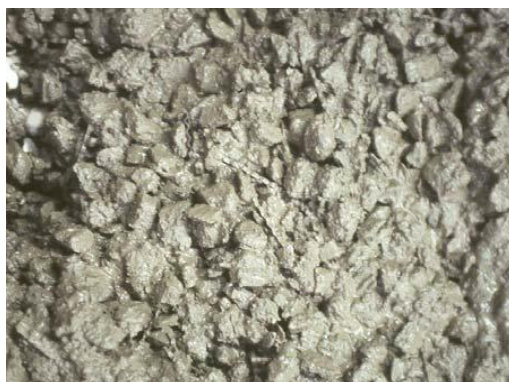
(c) Concreto com fibras de aço
