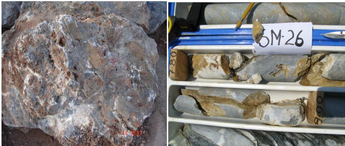
Figura 10 – Detalhes de dissoluções cársticas
