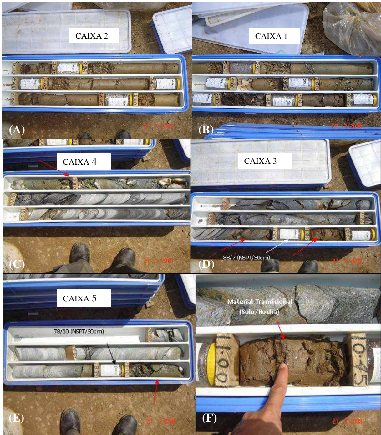
Figura 8 – Detalhe das caixas de testemunho (A – E) da sondagem (SM-19) executada na fundação do Bloco 4
