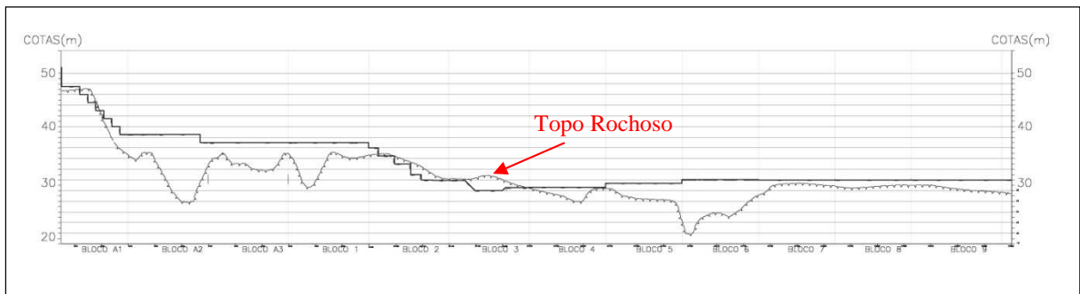
Figura 5 – Seção do Eixo da Barragem San Juan (vista de jusante) apresentando as cotas de fundação e topo rochoso estimado (vermelho). Escala original 1: 250.
