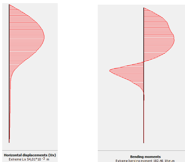
Figura 56 - Deslocamentos horizontais e momentos fletores na estaca E1-PE – sem colunas de brita
