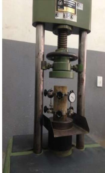
Figura 34 – Compressômetro e prensa hidráulica para ensaio de Módulo de Elasticidade Secante.
