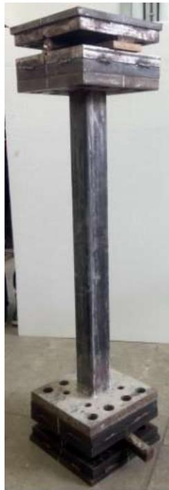
Figura 44 – Coluna bi-rotulada em relação ao eixo de menor inércia da seção transversal.
