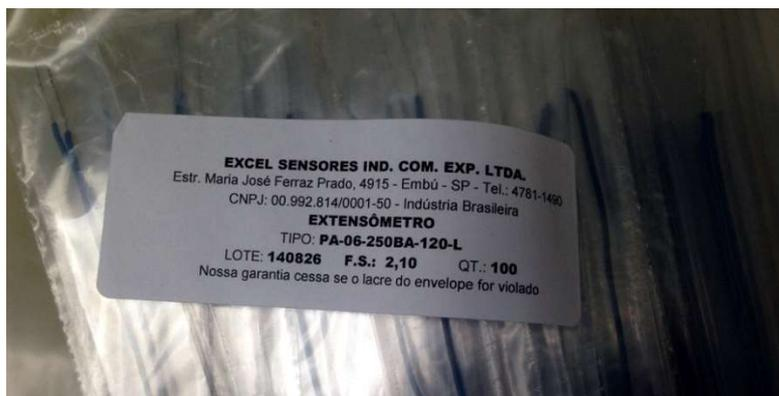
Figura 60 – Especificação do extensômetro usado nos pilares ensaiados.
