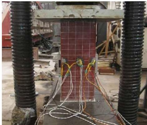
Figura 8 – Ensaio a compressão axial do pilar tubular de aço preenchido com concreto [31].
