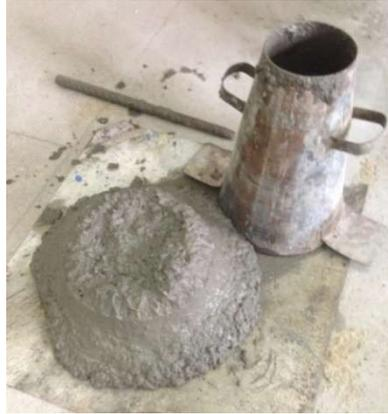
Figura 53 – Verificação do slump.
