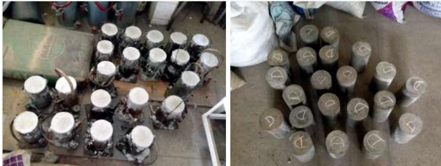
Figura 56 – Corpos de prova com moldes e desmoldados.
