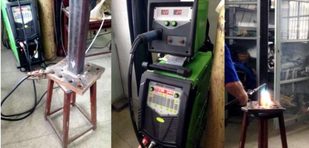
Figura 42 – Máquina de soldagem MAG e processo de solda.
