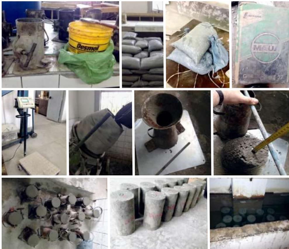
Figura 32 – Moldagem e retirada dos corpos de prova.
