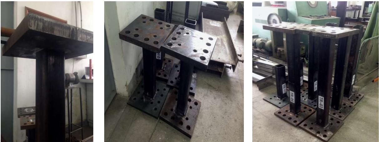
Figura 43 – Ponteamiento da solda com eletrodos e pilares apenas com aço com placas superior e inferior já soldadas.
