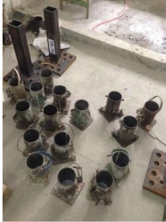
Figura 51 – Corpos de prova com desmoldante.
