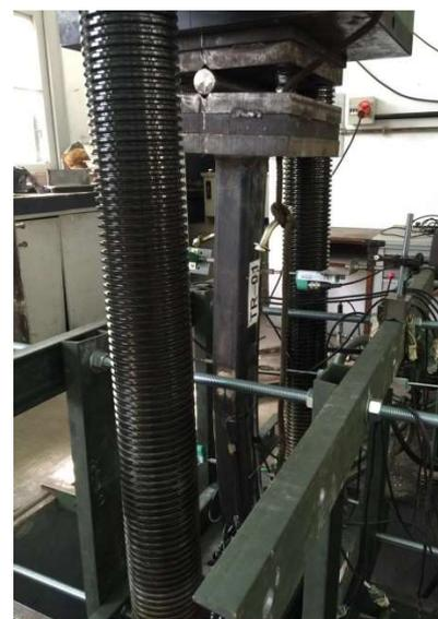
Figura 83 – Sistema de condição de apoio dos pilares, variando espessura das placas.
