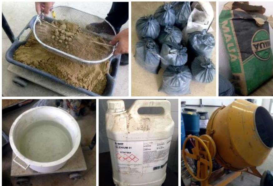
Figura 50 – Materiais sendo pesados para concretagem.
