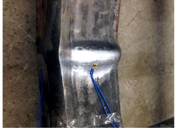
b) Pilar de aço e concreto armado com flambagem local.
