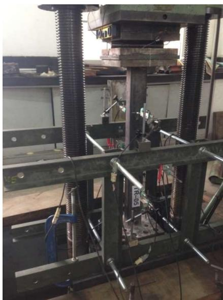
Figura 66 – Posicionamento dos transdutores de deslocamentos, ensaio TR-05\_A\_C\_B.
