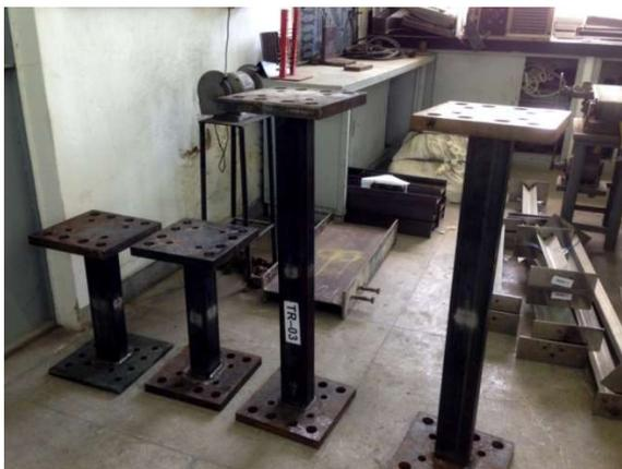
Figura 64 – Pilares metálicos instrumentados.
