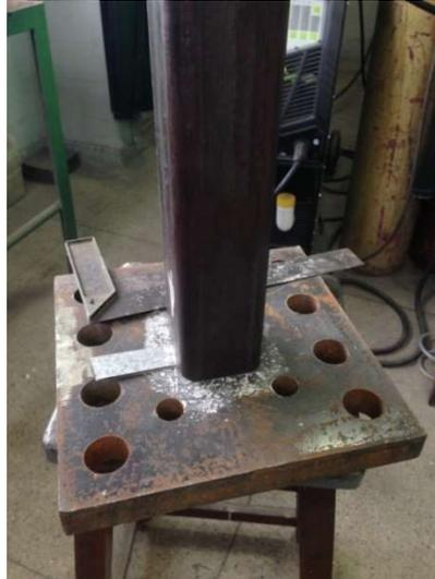
Figura 41 – Colocação de calços entre a placa de base e o perfil.
