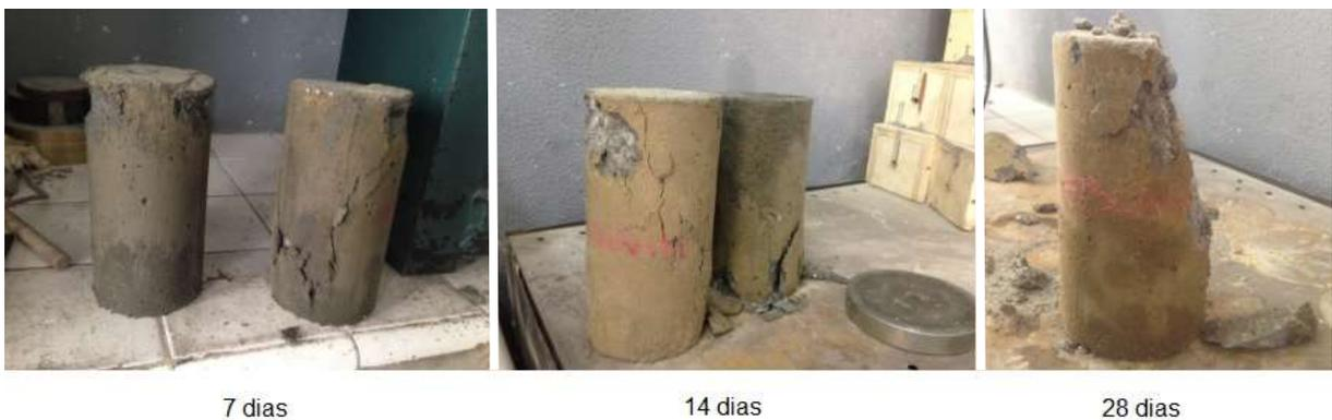
Figura 33 – Ruptura dos corpos de prova em diferentes idades de resistência.
