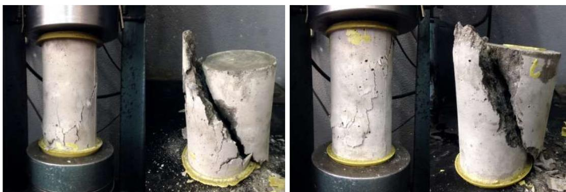
Figura 57 – Ruptura dos dois corpos de prova a 42 dias de resistência.
