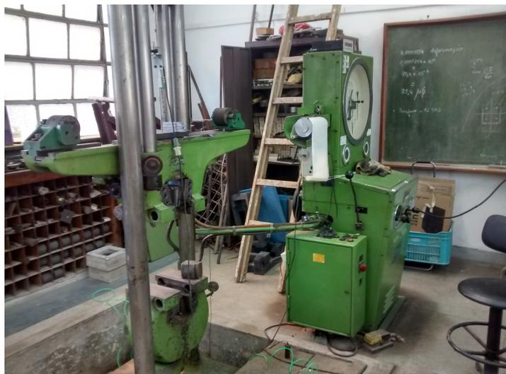
**Figura 19 – Máquina universal de ensaios Lousenhausen de 600kN**
