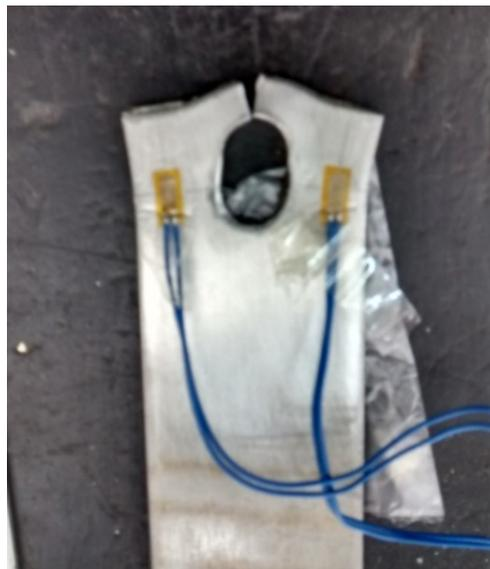
**Figura 21 – Configuração final após a ruptura – Aço inoxidável austenítico, um furo**
