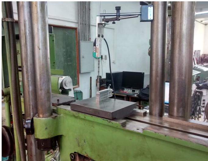
**Figura 18 – Transdutor linear de deslocamento, LVDT**
