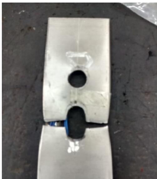
**Figura 29 – Configuração final após a ruptura – Aço inoxidável duplex, dois furos**
