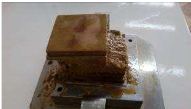
Figura 57 – Corpo de prova após o ensaio de cisalhamento direto
