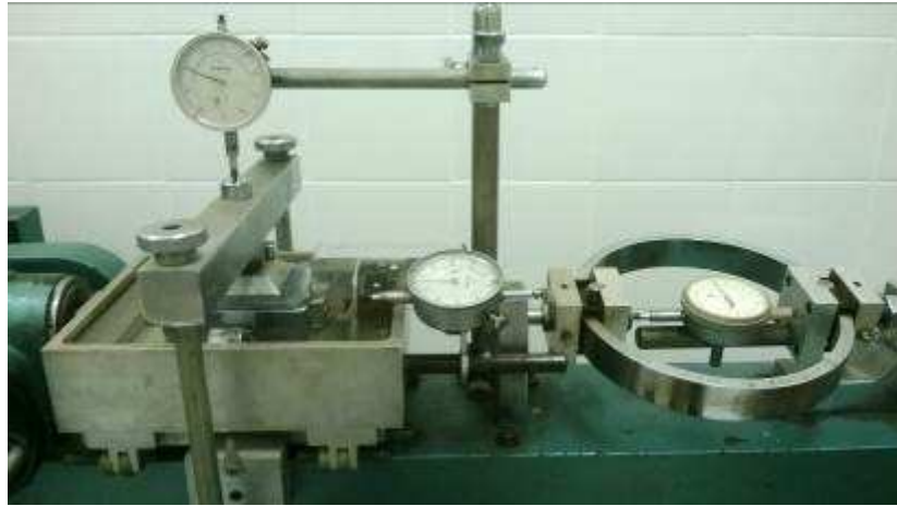
Figura 56 – Esquema do ensaio e extensômetros
