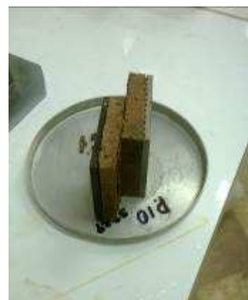
Figura 57 – Corpo de prova após o ensaio de cisalhamento direto
